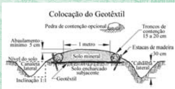
Figura 41 - Coloque o geotêxtil debaixo dos troncos ou pedras de contenção antes de estaqueá-lo no lugar.
