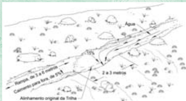
Figura 16 - Uma valeta de drenagem baseia-se no desenho de um bolsão de escoamento. Ela ajuda a desviar a água dos trechos mais íngremes de trilhas já existentes.
