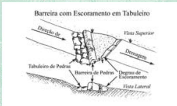
Figura 19 - Barreira de drenagem com escoramento em tabuleiro.
