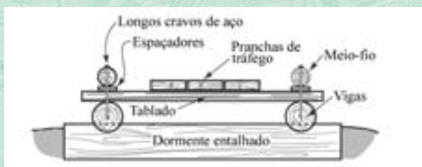
Figura 51 - Afaste as vigas o suficiente para suportar integralmente a largura do tablado.
