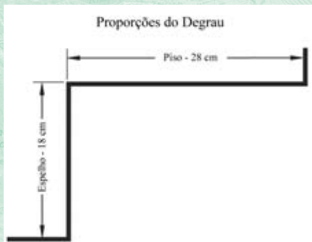
Figura 83 - Proporções do degrau: uma regra de bolso propõe que duas vezes a altura, mais a passada, deveriam totalizar entre 63 e 68 cm.
