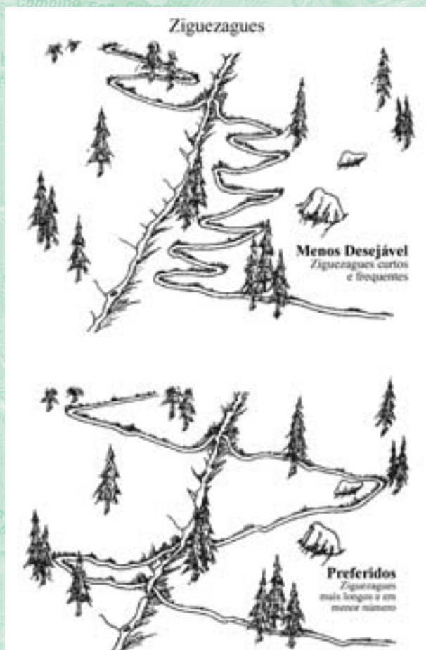
Figura 74 - Longas seções de trilha entre os ziguezagues são geralmente melhor do que seções mais curtas – menos ziguezagues serão necessários com menos cantos onde criar algum atalho..
