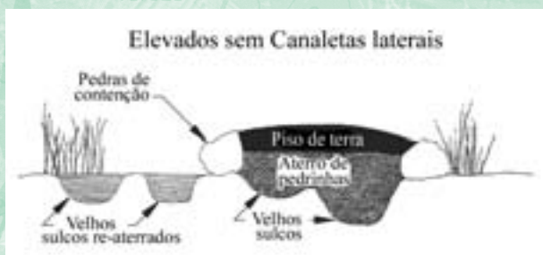
Figura 46 - Elevados sem valetas, algumas vezes chamados passarelas elevadas, criam um piso mais alto e endurecido através de áreas sazonalmente encharcadas e podem substituir múltiplos trilhos paralelos que são convenientemente aterrados.
