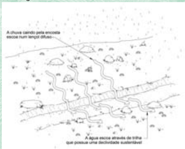
Figura 10 - Elementos de design para uma trilha curvilínea deixam o fluxo da água escoar através do piso. O escoamento difuso impede a água de ser canalizada ao longo da trilha, onde ela causaria erosão.
