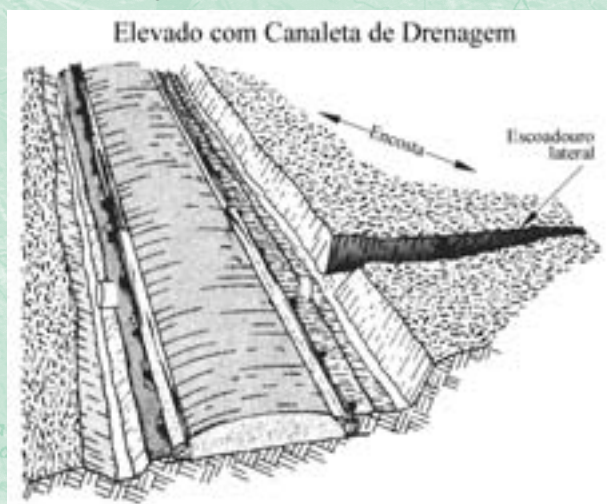
Figura 40 - Pisos elevados erguem uma trilha acima do solo encharcado.
