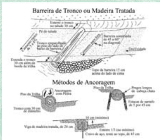
Figura 17 - Troncos usados pela drenagem precisam ser descascados ou tratados e enfiados menos de 30cm em encosta adentro, espequeados ou ancorados, mas quase totalmente enterrados.
