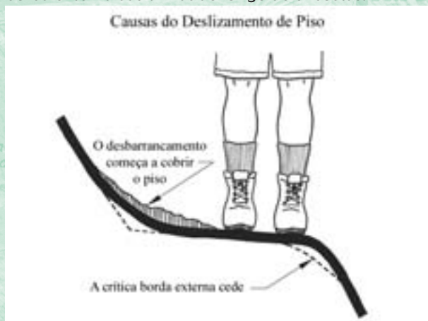
Figura 32 - O deslizamento do piso em marcha - pequenos desbarrancamentos e terra arrancada das beiradas.
