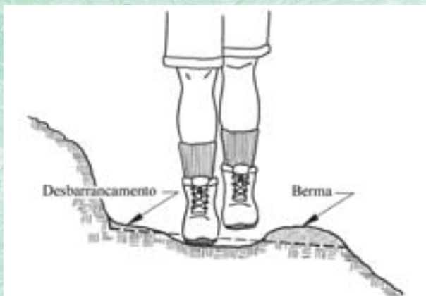
Figura 30 - Remova o desbarrancamento e a berma, refazendo o calçamento para fora de modo que a água possa escoar e escapar.
