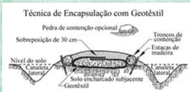
Figura 43 - A encapsulação com geotêxtil é outra maneira de erguer uma trilha acima de áreas encharcadas.
