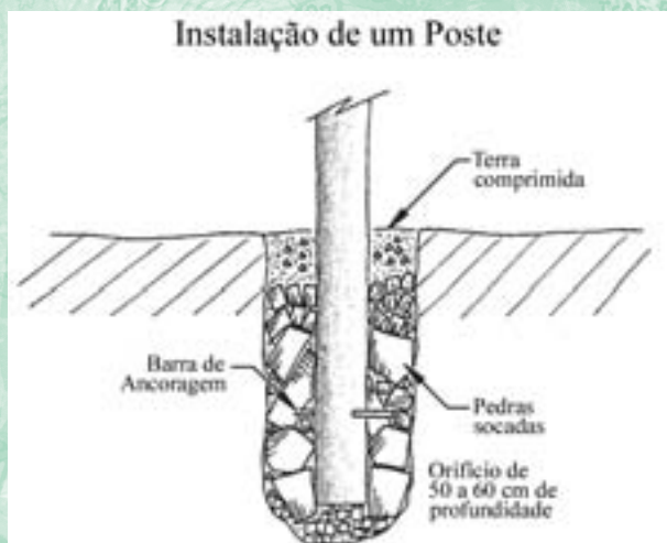
Figura 87 - Instalação do poste para a placa: a dica para fixar postes sólidos é compactar as pedras e a terra com um pilão ou cabo de alguma ferramenta, enquanto se enche o buraco.
