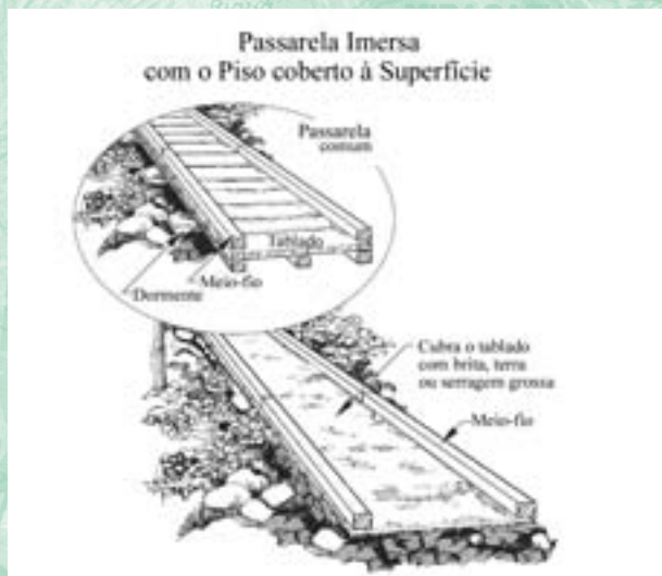
Figura 53 - Cubra a superfície do piso entre os meio-fios com brita, serragem e restos de madeira ou terra para manter tudo molhado, impedindo que a estrutura apodreça.
