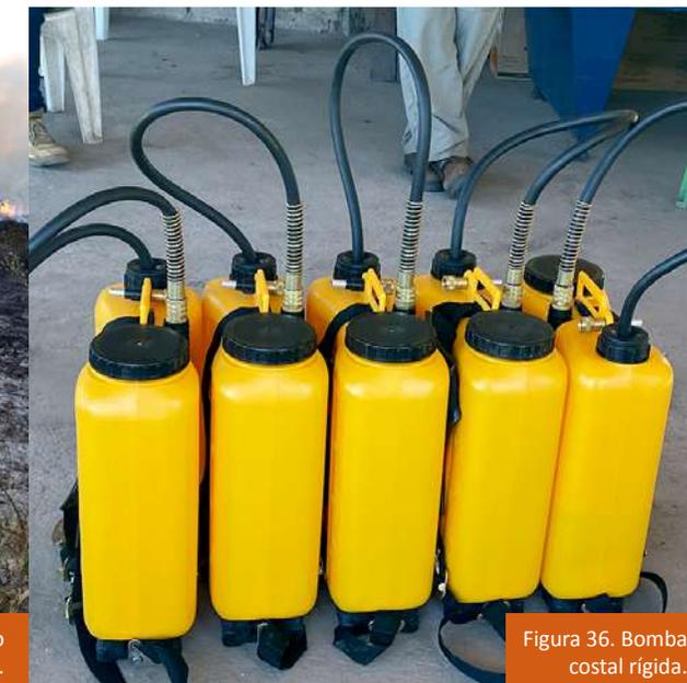
Figura 36. Bomba costal rígida.
