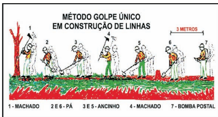
Figura 32 – Esquema ilustrando abertura de linha de controle pelo método progressivo funcional. (Modificado de Ramos, 2004)
