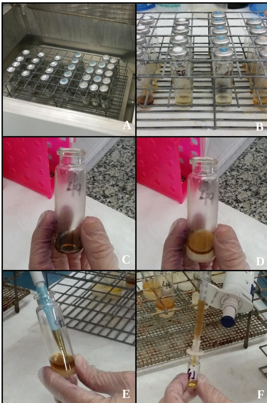
Figura 14. Obtenção dos ésteres metílicos de ácidos graxos (FAME; “fatty acid methyl ester”). A – Início da reação de transesterificação, frascos em banho-maria (100 °C) por 1 hora; B – Frascos esfriando após banho-maria; C-D-E – Separação e recuperação dos FAMES; F – Filtração dos FAMES
