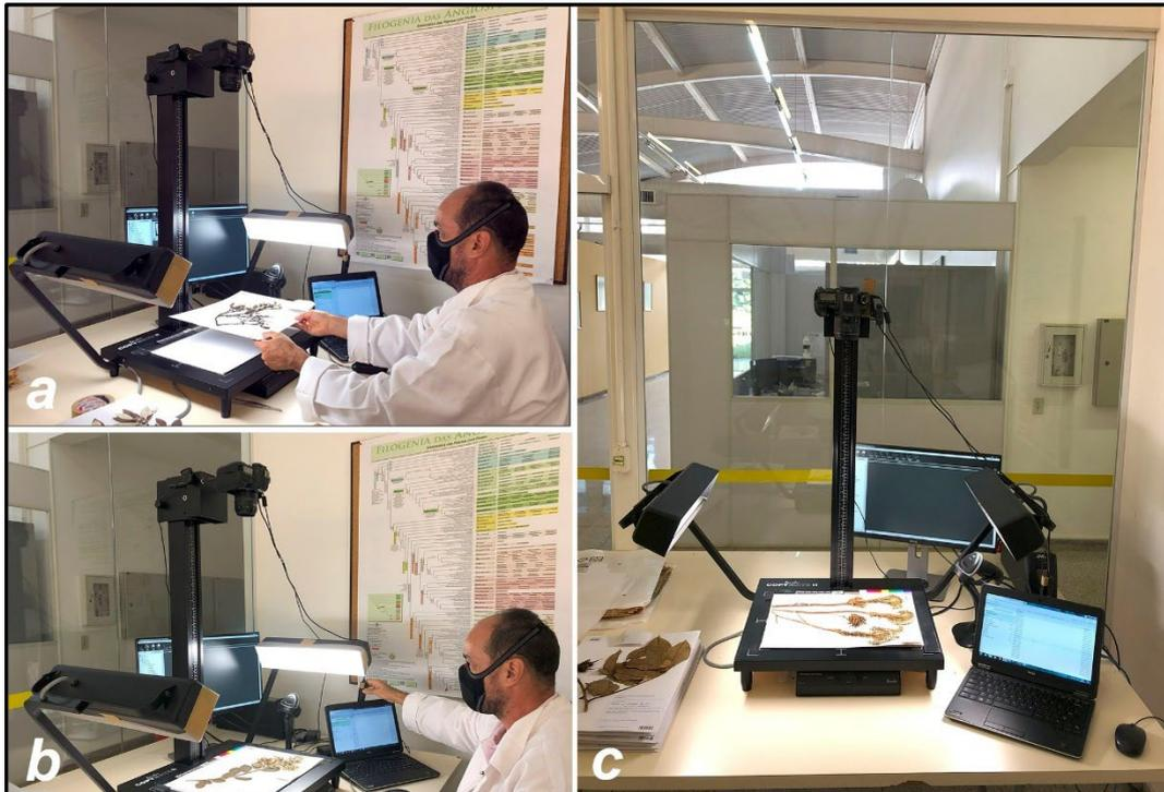
Figura 39. Processo de digitalização da exsicata. a) acomodação do material na mesa estativa; b) acionamento remoto da câmera; c) detalhe da estação.
