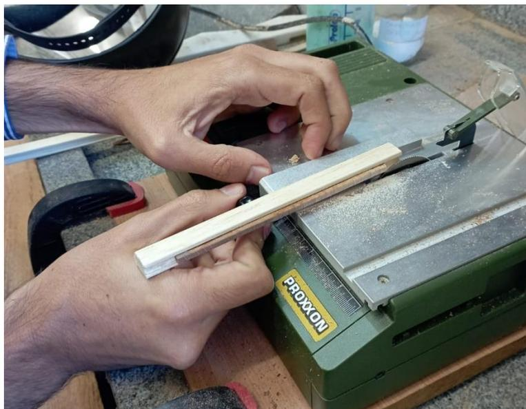
Figura 5: Secção das amostras de *Cedrela fissilis* no equipamento Proxxon ks230.
