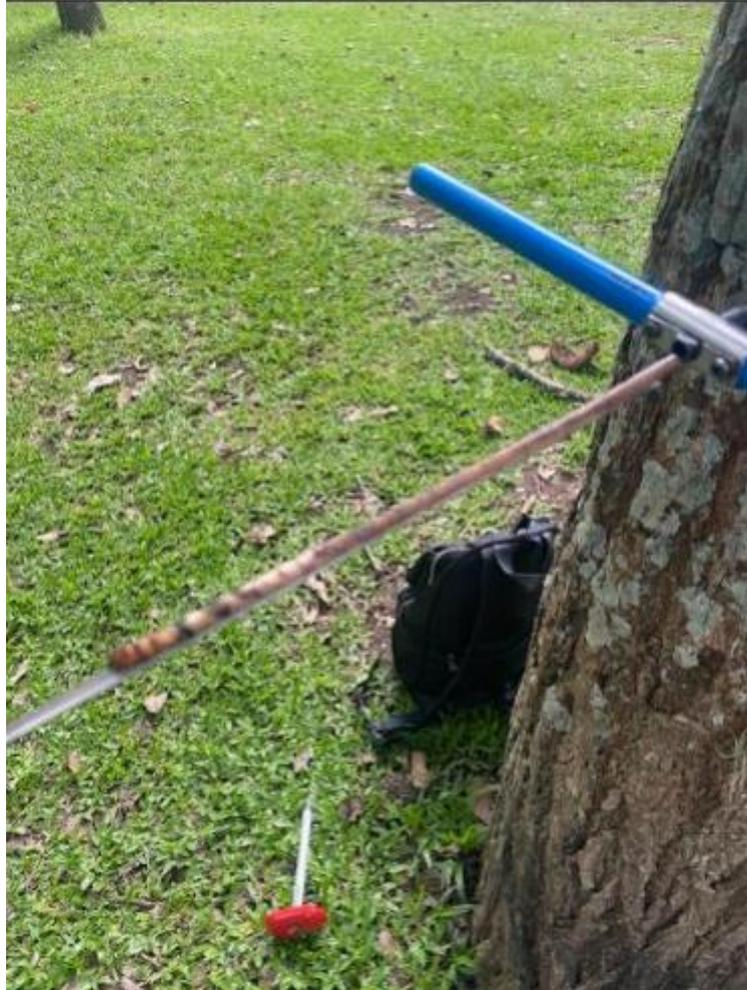
Figura 1: Trado de incremento manual usado para coleta da espécie *Cedrela fissilis*.
