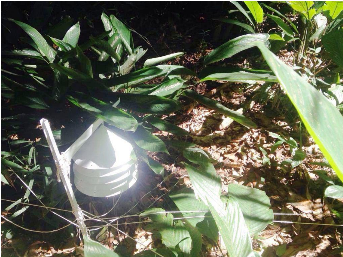
Figura 4 – Sensores para caracterização microclimática no campo instalados em miniabrigos de ventilação passiva.
