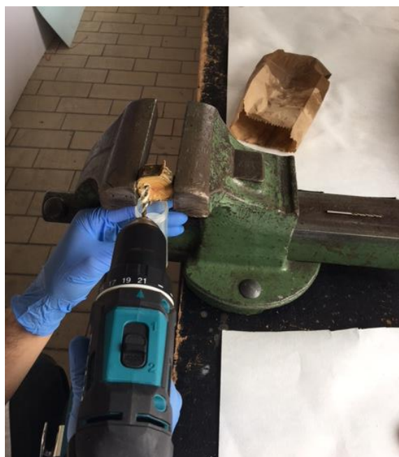
Figura 5 – Laboratório da Universidade de Copenhagen. Fragmentação das amostras com furadeira e broca.
