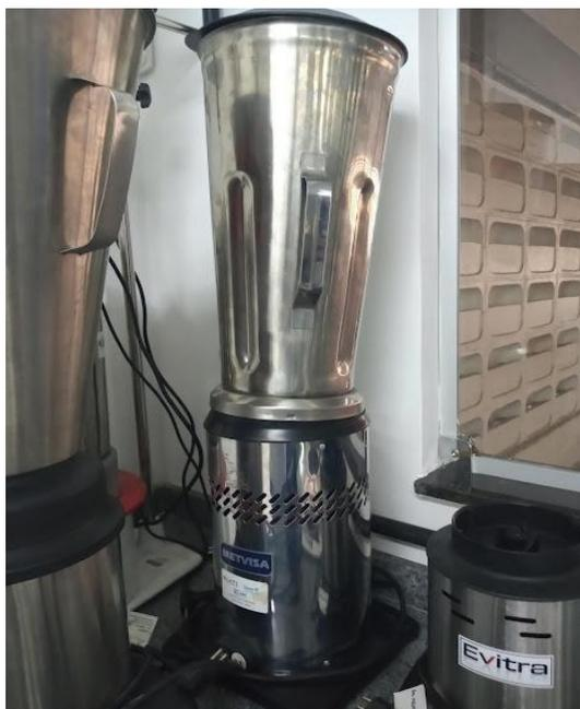
**Figura 4.** Liquidificador industrial com capacidade de até 2 L, e velocidade de 2.000rpm, usado como ferramenta para triturar as algas desidratadas.
