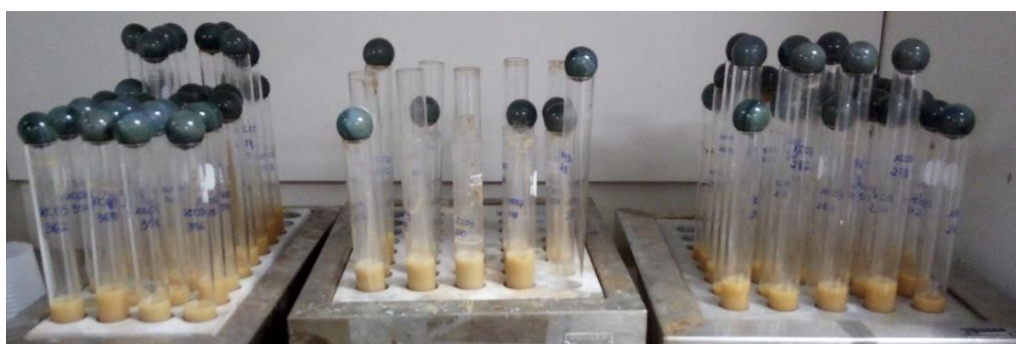
Figura 3. Oxidação das subamostras de diatomáceas em blocos digestores a 80°C.
