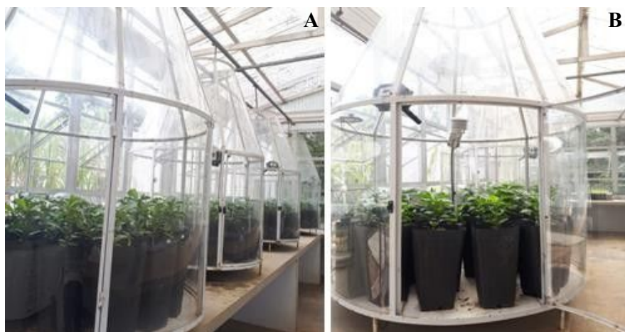
Figura 5: Vista geral das quatro OTCs na Casa de Vegetação - Núcleo de Pesquisa em Fisiologia e Bioquímica (A); Sensores de monitoramento da radiação solar, temperatura e umidade relativa no interior de uma câmara e cafeeiros submetidos a diferentes tratamentos (B).
