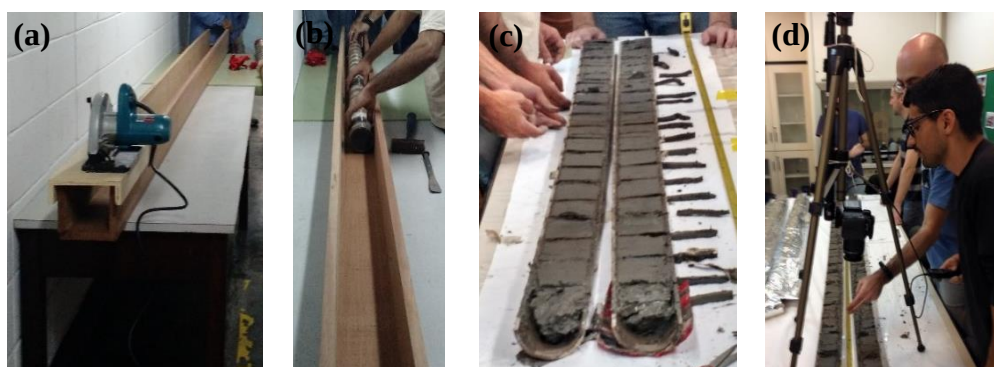
Figura 3. (a e b) Detalhamento da abertura longitudinalmente do perfil. (c) Demonstração do testemunho aberto. (d) Demonstração da litologia fotográfica.
