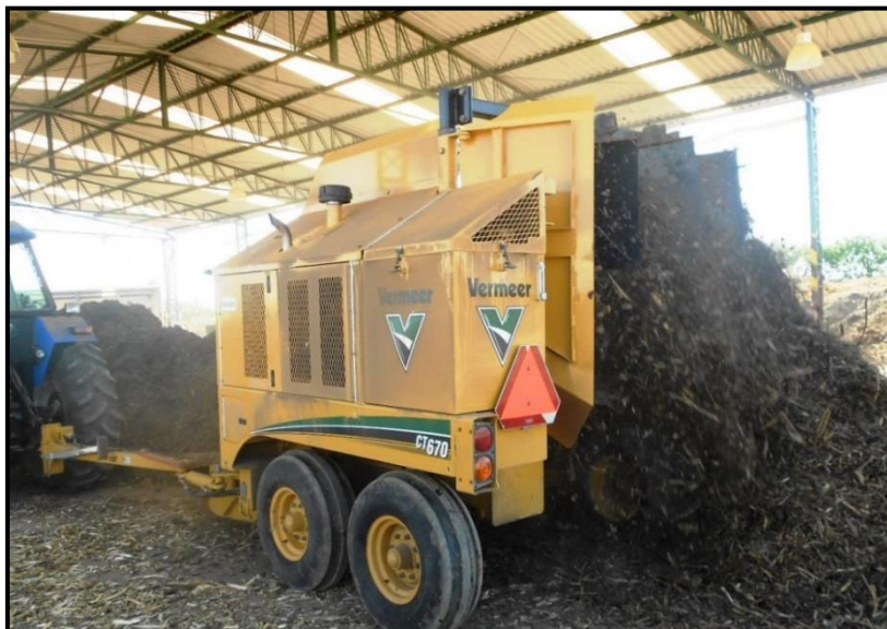
Figura 2. Homogeneização dos resíduos após pesagem e recebimento com uso de equipamento específico para o processo.
