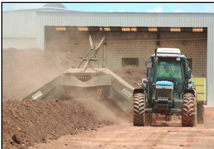
Figura 5. Revolvimento mecânico no pátio de cura visando a estabilização e humificação do composto orgânico
