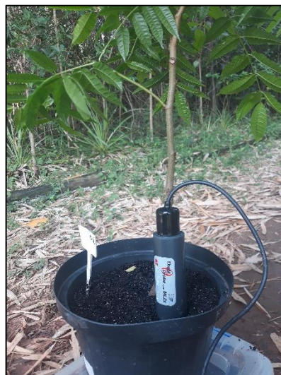
Figura 5: Medição da umidade relativa do solo pelo método TDR com um Mini Trase.
