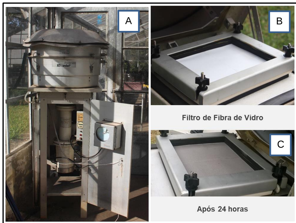
Figura 4. Amostrador de partículas atmosféricas de grande volume de ar. (B) suporte que prende o filtro e filtro de fibra de vidro recém colocado. (C) Filtro de fibra de vidro após exposição de 24 horas
