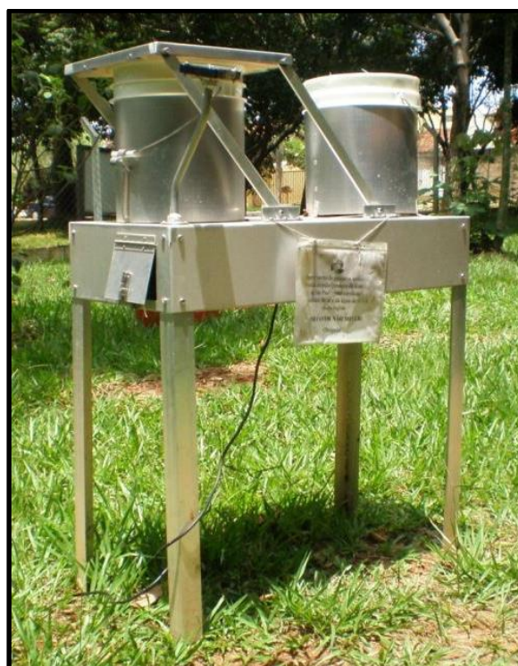
Figura 5. Coletores automáticos de deposição atmosférica seca e úmida.
