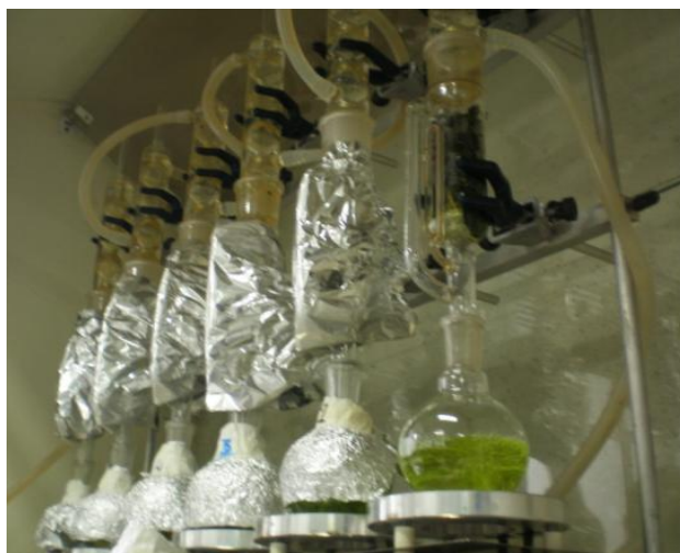
Figura 6. Conjunto de extratores Soxhlet utilizados para a extração de HPAs nas folhas, solo, filtros MP 10 e deposição seca.
