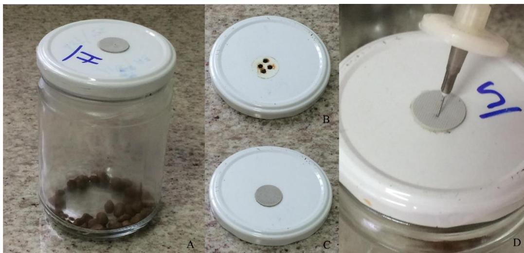
**Figura 1.** Frascos de vidro de 600 mL com fechamento hermético (A) e tampa perfurada (B), recoberta por septo de borracha (C), por onde se fez a coleta da amostra de ar (D).
