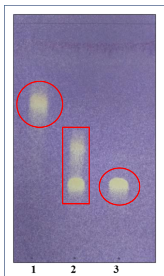
Figura 14 - Foto da placa cromatográfica (CCD, em sílica gel F 254 eluída em BAW) 1 – PFFR3.1; 2– PFFR3.2; 3 – PFFR3.3. Revelada com DPPH sob luz branca.
