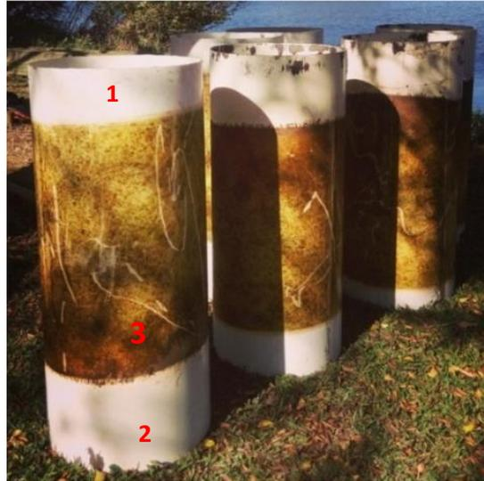
Figura 2. Cilindros de PVC usados como mesocosmos, sendo evidenciada a parte branca que ficou fora da água (1), parte branca que ficou enterrada com restos de argila (2) e parte escura com algas aderidas e outros materiais (3).
