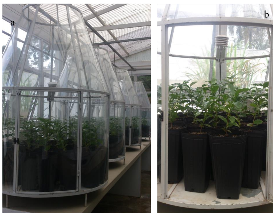
Figura 1.1. (A) Vista geral das quatro OTCs instaladas no Núcleo de Pesquisa em Fisiologia e Bioquímica do Instituto de Botânica. (B) Plantas de C. arabica e os sensores de monitoramento da radiação solar, temperatura e umidade relativa no interior da câmara.
