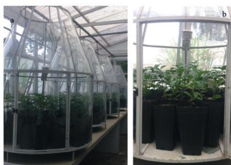
Figura 1. (a) Vista geral das quatro OTCs instaladas no Núcleo de Pesquisa em Fisiologia e Bioquímica do Instituto de Botânica. (b) Plantas de C. arabica e os sensores de monitoramento da radiação solar, temperatura e umidade relativa no interior da câmara.
