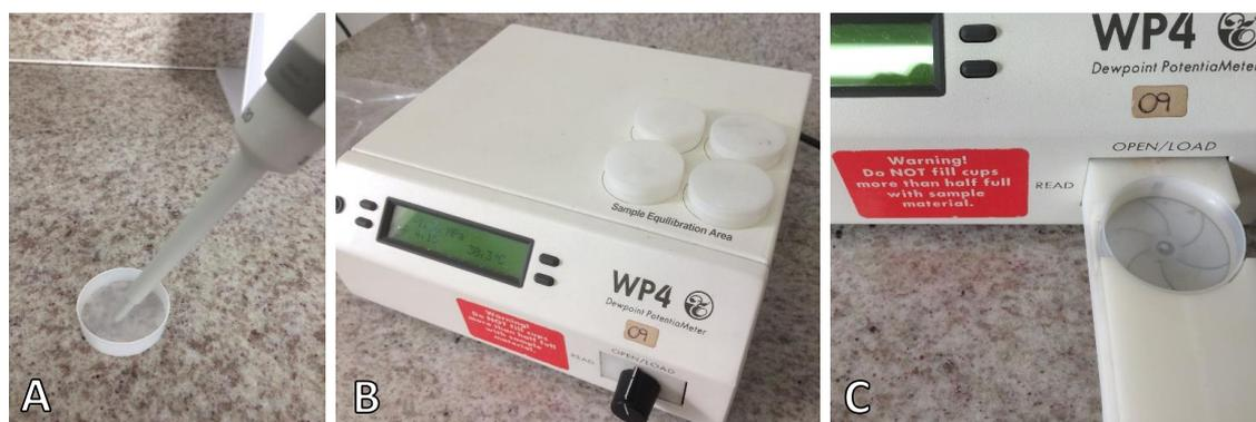
Figura 2. Avaliação do potencial hídrico de soluções de PEG. A. Solução de PEG pipetada na cápsula de avaliação; B. Cápsulas com as amostras aguardando estabilização térmica; C. Cápsula com a solução de PEG prestes a ser inserida na câmara de avaliação.
