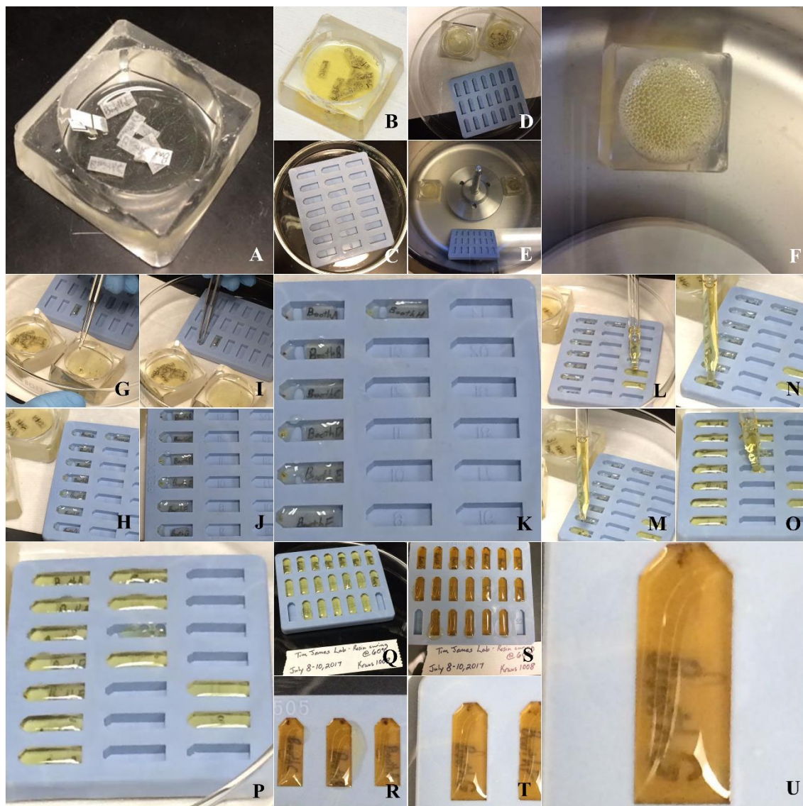
Figura 15 A-U. Última etapa da preparação da resina e adição dos blocos de ágar nos moldes
