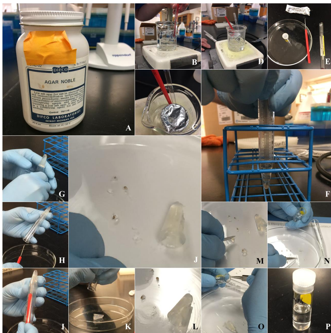
Figura 12 A-P. Infusão do “pellet” com 2% de ágar nobre. A-E. Preparação do ágar nobre. F. Adição de ágar nobre líquido. G-I. Remoção do ágar solidificado do tubo de vidro. J-N. Dissecção do bloco de ágar em blocos menores. O-P. Adição de água deionizada ultrapura
