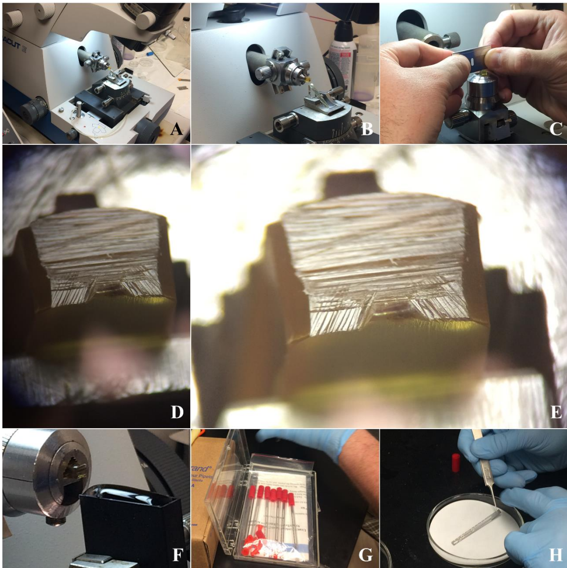
Figura 16 A-H. Secção dos blocos moldados em um ultra micrótomo e adição das secções em anéis de níquel
