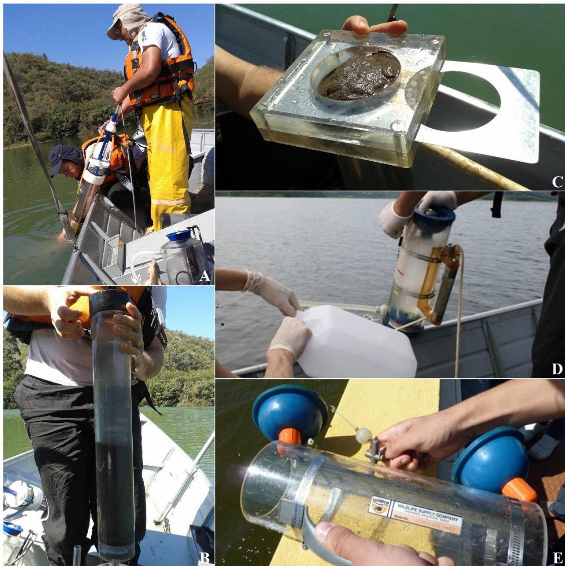
Figura 5 A-E. Equipamentos utilizados para coleta de água e sedimento. A-C. Testemunhador de gravidade UWITEC. D-E. Garrafa de Van Dorn
