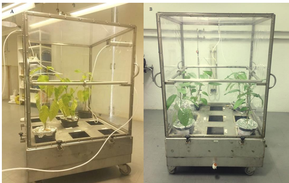
Figura 6. Vista lateral (A) e frontal (B) das câmaras revestidas com Teflon associadas ao sistema de fumigação do Laboratório de Interação Atmosfera-Planta no Instituto de Botânica de São Paulo.
