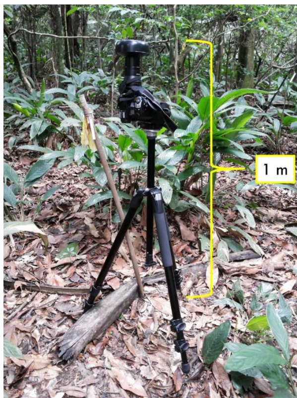
Figura 7. Câmera fotográfica digital Nikon Coolpix 4.300 com lente hemisférica Nikon FC-E8 Fishey acoplada, sobre um tripé a 1 m do solo no centro da parcela, exemplificando a metodologia de obtenção das fotografias hemisféricas.
