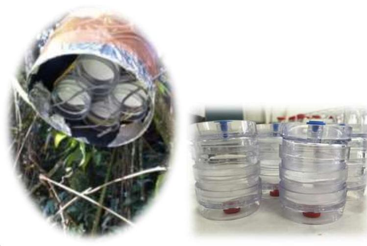
**Figura 4. A:** Amostradores passivos de NO<sub>2</sub> expostos durante uma semana nas três áreas de estudo (PP, PEFI, MSG). **B:** Amostradores mostrados em detalhe após a exposição de uma semana para análise em laboratório (Bocuzzi, 2014).
