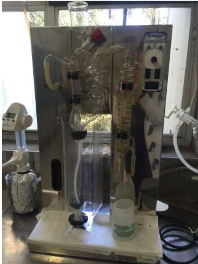
**Figura 8.** Microdestilador Kjeldahl para determinação de  $\text{N-NH}_4^+$  e  $\text{N-NO}_3^-$  nas amostras de folhas, serapilheira e solo (Boccuzzi, 2016).
