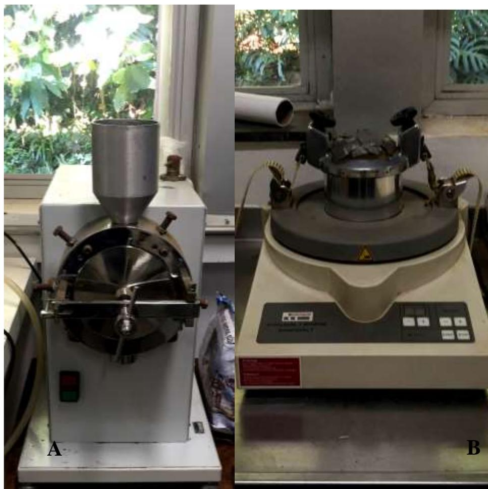
**Figura 7.** A: Moinho de lâminas utilizado para as amostras secas de serapilheira. B: Moinho de bola de ágata para as amostras secas de folhas (Boccuzzi, 2015).
