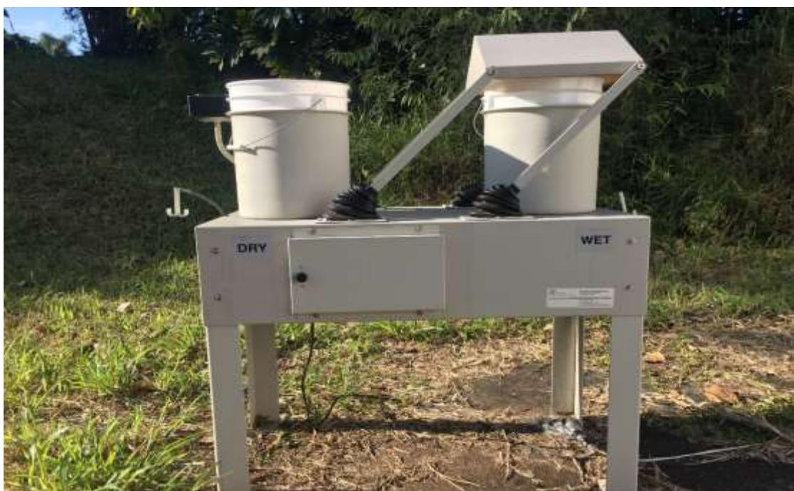
**Figura 5.** Amostrador do tipo APS (Acid Precipitation Sampler), instalado em clareiras, nas proximidades de cada remanescente florestal (PP, PEFI, MSG) (Boccuzzi, 2015).
