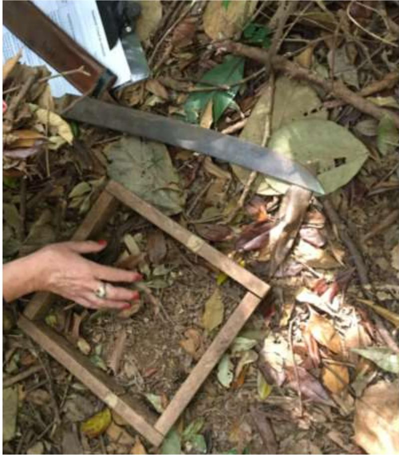
**Figura 6.** Gabarito quadrado com  $0,0625 \text{ m}^2$  de área para coleta de serapilheira acumulada sobre o solo (Bocuzzi, 2015).
