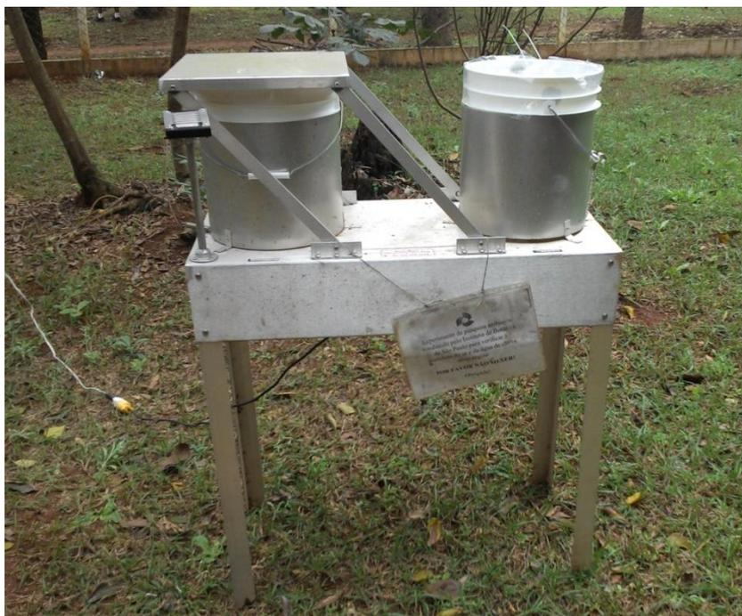
**Figura 3. Coletor de deposição atmosférica modelo APS. Coletor direito: Deposição seca. Coletor esquerdo: Deposição úmida.**
