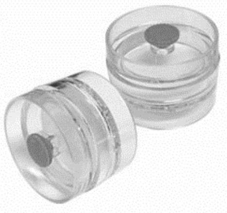
**Figura 2. Aparato amostrador acoplado ao sistema coletor de MP total nos diferentes locais de estudo. O pino preto é retirado durante a amostragem.**
