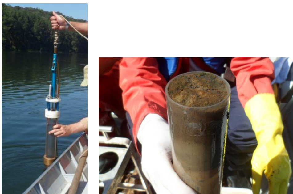
Figura 9. Amostragem dos sedimentos superficiais com auxílio de testemunhador de gravidade.
