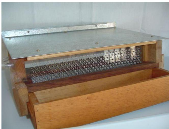
**Figura 14:** Coletor de pólen do tipo alvado para colmeias do tipo Langstroth utilizado para a coleta das cargas de pólen nos apiários da Comunidade Quilombola Porto Velho, Iporanga – SP. (Fonte: Apicola 2015).
