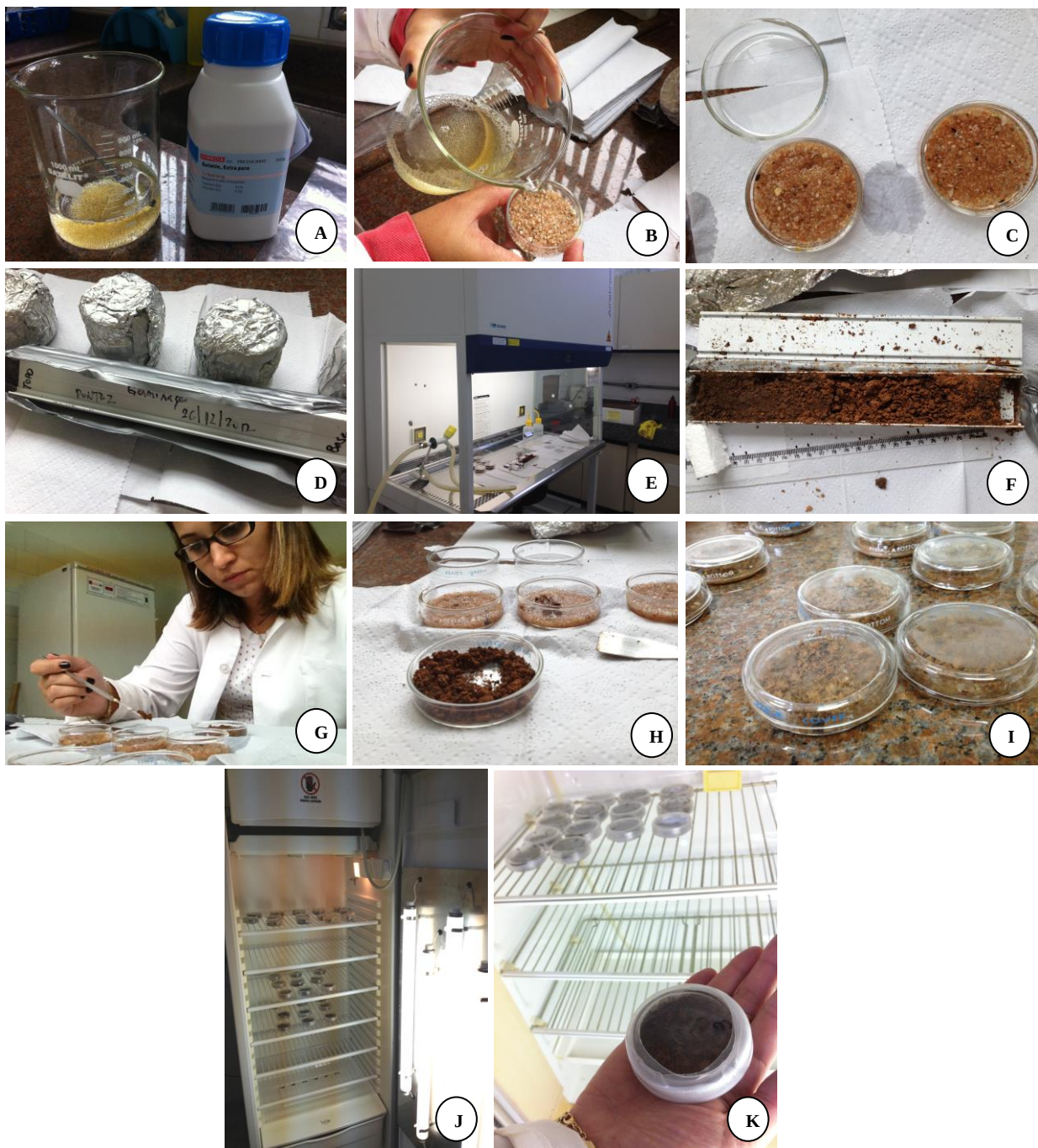
Figura 87. A-K. Preparação laboratorial das amostras de solo coletados nos quatro pontos de estudo no Parque Estadual das Fontes do Ipiranga (PEFI) para estudos de germinação dos esporos. A-B. Gelatina utilizada para umidificar as placas. C. Areia utilizada para deposição do solo amostrado. D. Perfil de solo coletado. E. Câmara de fluxo laminar. F. Abertura do perfil para amostragem dos níveis estratigráficos. G-I. Montagem das placas de Petri. J. Câmara de Germinação. K. Placas de Petri seladas com as amostras de solo.
