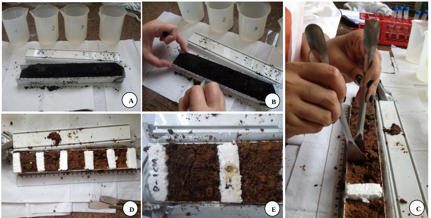
Figura 68. A-E. Preparação do perfil de solo dos pontos amostrados para a análise palinológica. A. Abertura da canaleta. B. Delimitação no perfil dos níveis estratigráficos. C. Nível estratigráfico sendo retirado para tratamento físico-químico. D. Perfil de solo após a retirada das amostras estratigráficas. E. Detalhe do perfil de solo após a retirada das amostras estratigráficas. As lacunas foram preenchidas com isopor mantendo o perfil intacto e não ocorrendo a mistura de materiais.
