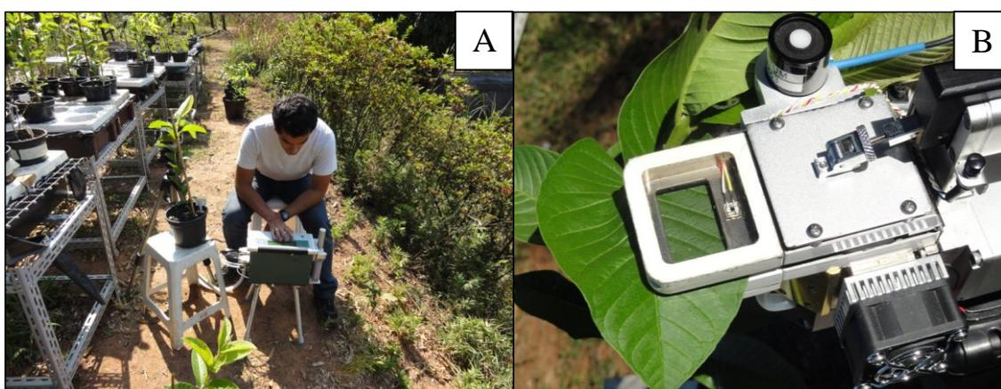
**Figura 7.** A) Medidas de condutância estomática em *Psidium guajava* ‘Paluma’. B) Folha com limbo totalmente expandida acoplada à câmara do analisador de trocas gasosas.
