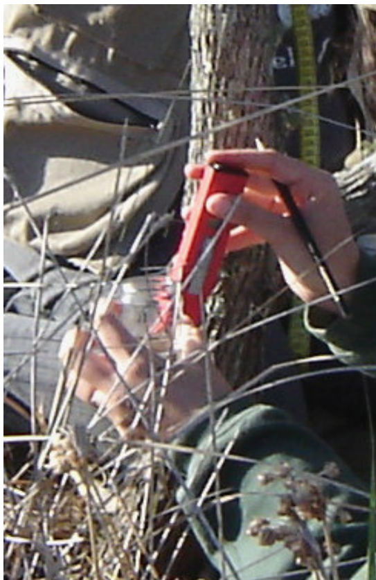
Figura 4. Determinação do pH da casca com o auxílio do medidor digital portátil PH-1700.
