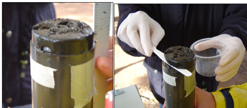
Figura 8. Fatiamento do testemunho em intervalos regulares de 1 cm.
