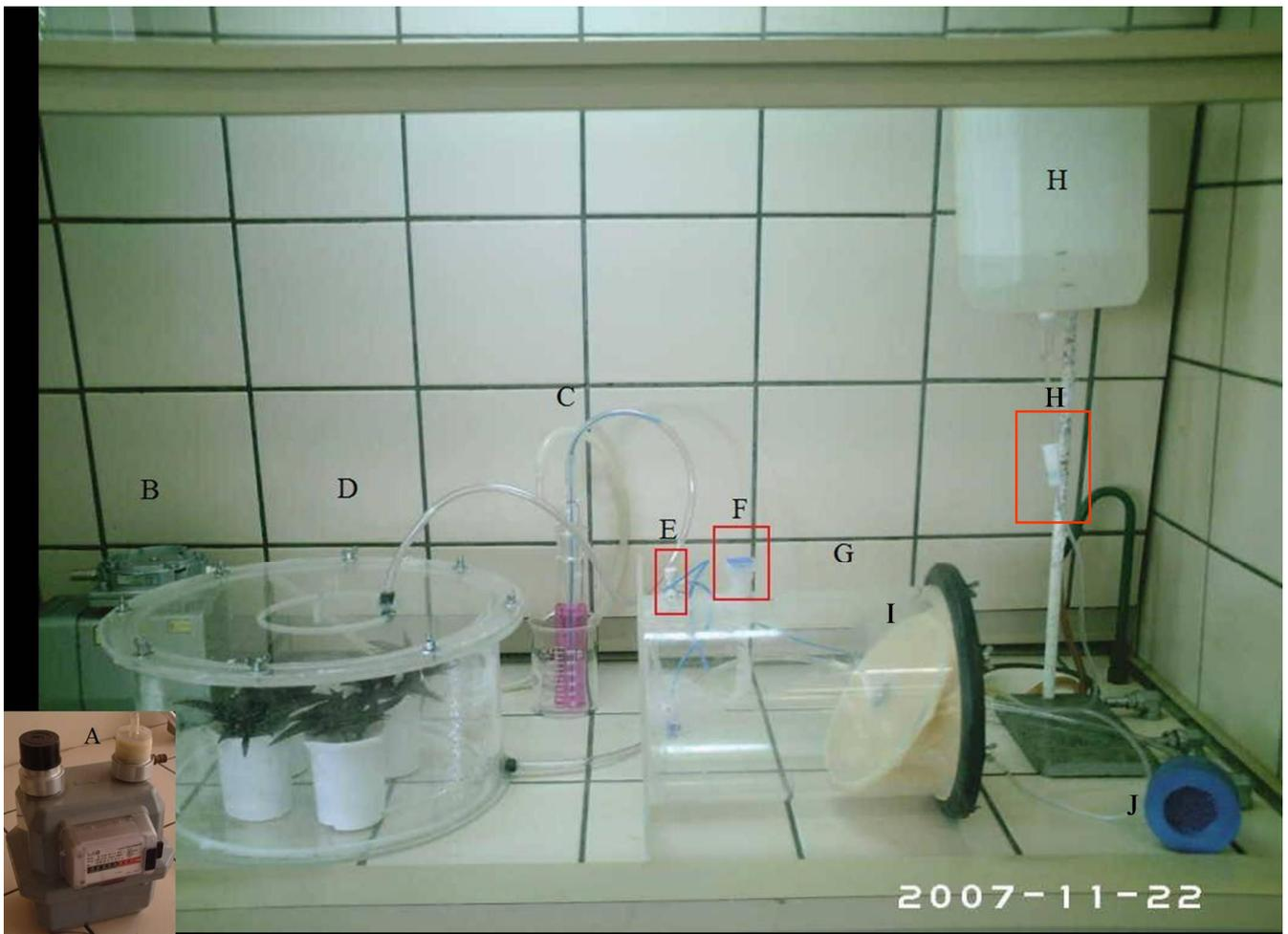
Figura 5. Sistema operacional para exposição de *T. pallida* ao ácido fluorídrico. A. medidor de volume; B. bomba de vácuo; C. frasco borbulhador para neutralização e coleta; D. câmara de exposição com as inflorescências; E. válvula de injeção de  $H_2SO_4$ ; F. orifício para entrada de NaF; G. câmara de produção e armazenamento de ácido fluorídrico; H. sistema de gotejamento, I. dispositivo tipo êmbolo; J. filtro de carvão ativado.
