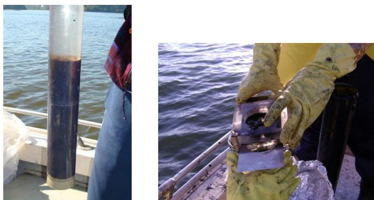
**Figura 7.** Amostragem dos sedimentos superficiais com auxílio de testemunhador de gravidade.**Tabela 3.** Síntese do número de amostras de água, fitoplâncton e sedimentos superficiais por compartimento e período climático (inverno e verão) no Complexo Billings.
