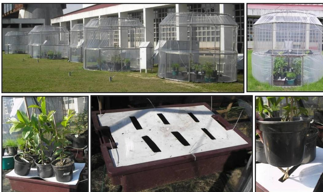
**Figura 5.** Câmaras de topo aberto instaladas no CEPEMA e detalhes do modo de exposição.
