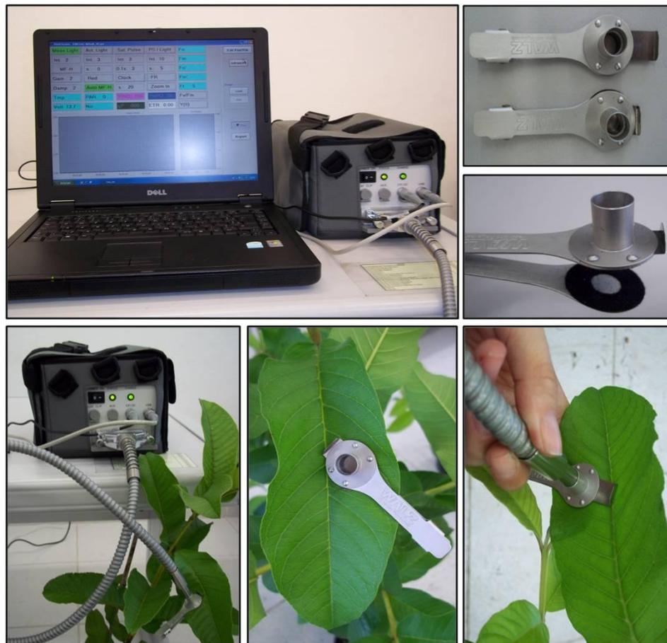
**Figura 7.** Determinação da razão  $F_v/F_m$  com um fluorômetro modulado.
