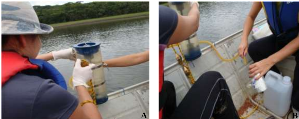
Figura 6. Amostragem da coluna d'água no Sistema Alto Cotia. A: coleta com garrafa de van Dorn e B: subamostra para análise de oxigênio dissolvido.
