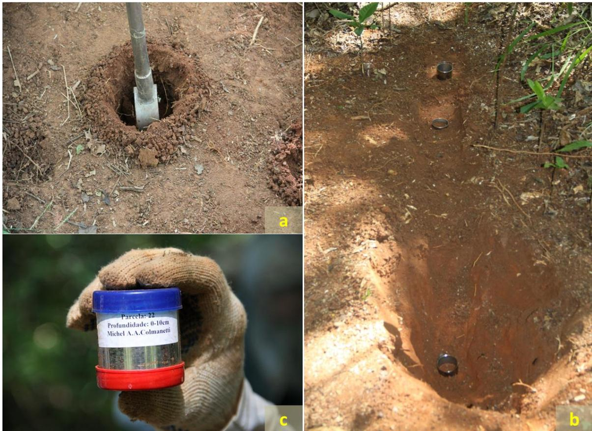
**Figura 11:** Coleta de amostras para análises química e física dos solos da RPPN, Parque São Marcelo, Mogi-Guaçu/ SP. a – Método de amostragem com trado holandês para análise química do solo; b – Método de amostragem com anel volumétrico para análise física do solo, em três profundidades (0-10, 0-20 e 20-40 cm); c – Anel volumétrico utilizado para coleta de solo.
