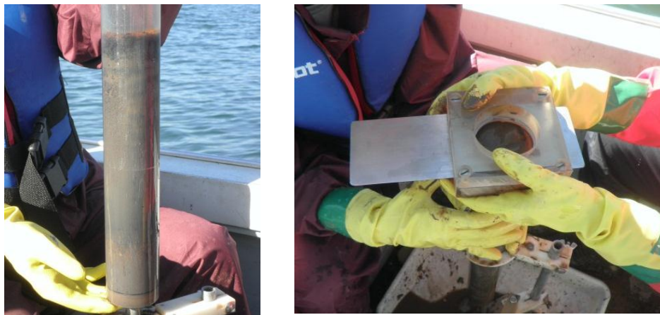
Figura 12. Amostragem e fatiamento do sedimento superficial com auxílio de testemunhador de gravidade.
