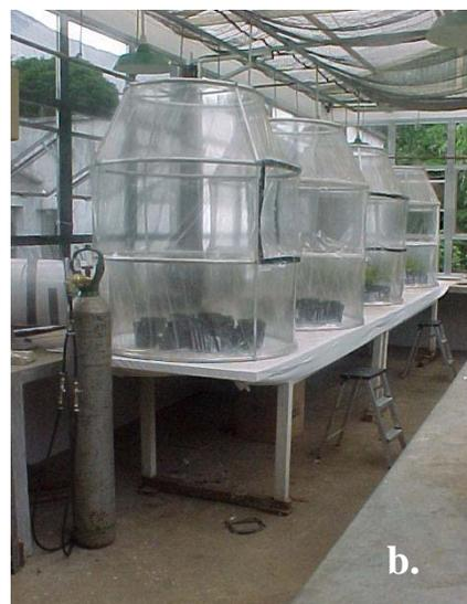
**Figura 2.1.** (a) Esquema do sistema das câmaras de topo aberto (CTA) utilizadas para o crescimento das plântulas: 1 – cilindro de CO<sub>2</sub>; 2 – válvula; 3 – tubulação; 4 – tomada de ar externo; 5 – filtro de partículas em suspensão; 6 – ventilador; 7 e 8 – plântulas; 9 – termômetro; 10 – sensor de CO<sub>2</sub> (adaptado de Aidar et al. 2002); (b) Posicionamento das CTAs no local de estudo.
