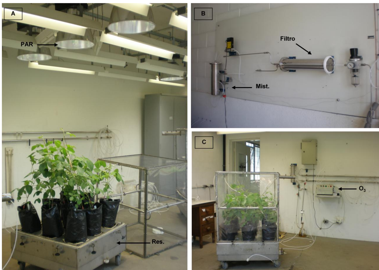
Figura 12. Sistema de fumigação ou atmosfera controlada. A: Plantas de soja acomodadas nos espaços do reservatório de água na base da câmara; B: Painel com filtro e misturador de ar; C: Câmara fechada e conectada à tubulação com ar filtrado enriquecido com ozônio. Abreviaturas: PAR: lâmpadas que emitem PAR; Res: reservatório de água; Mist: misturador de ar; O 3 : ozonizador.
