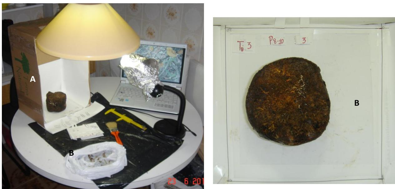
**Figura 14.** Estúdio adaptado para fotografar peças “P” e “M”. **A.** Orifício de encaixe da câmera fotográfica. **B.** Vista frontal da objetiva da câmera e foto da peça com fundo de 20,0cm x 20,0cm.
