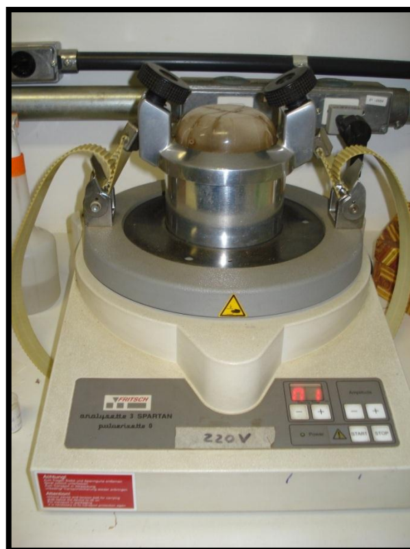
Figura 6. Micro moinho vibratório de bola confeccionada em ágata (Vibratory micro-mill Pulverisette – Fritsch), utilizado para moagem das folhas.
