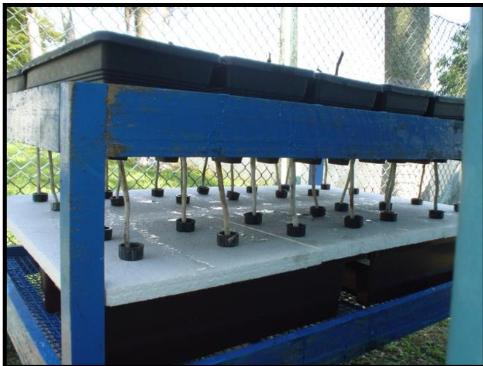
Figura 3. Mesa para irrigação contínua mediada por cordões de náilon
