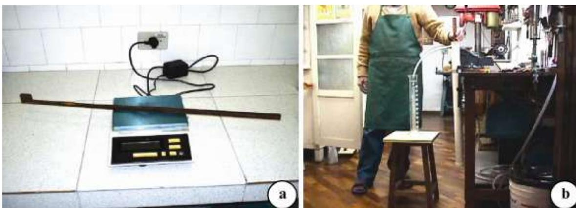
Figura 2. Determinação da densidade aparente. a. Obtenção da massa das varetas. b. Verificação do volume deslocado pelas varetas quando imersas em água.
