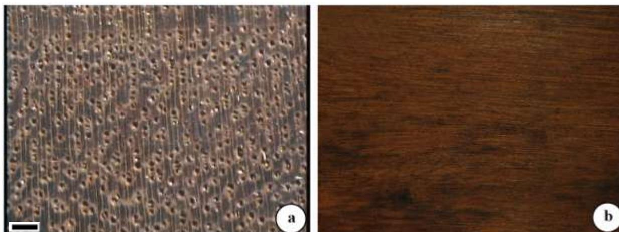
Figura 7. Madeira de *Caesalpinia echinata*. a. Fotomacrografia do plano transversal da madeira. b. Fotografia da superfície longitudinal tangencial dessa madeira. Comparar com as figuras 8 e 9, que mostram as respectivas imagens para as demais madeiras estudadas. Barra = 500 $\mu$ m
