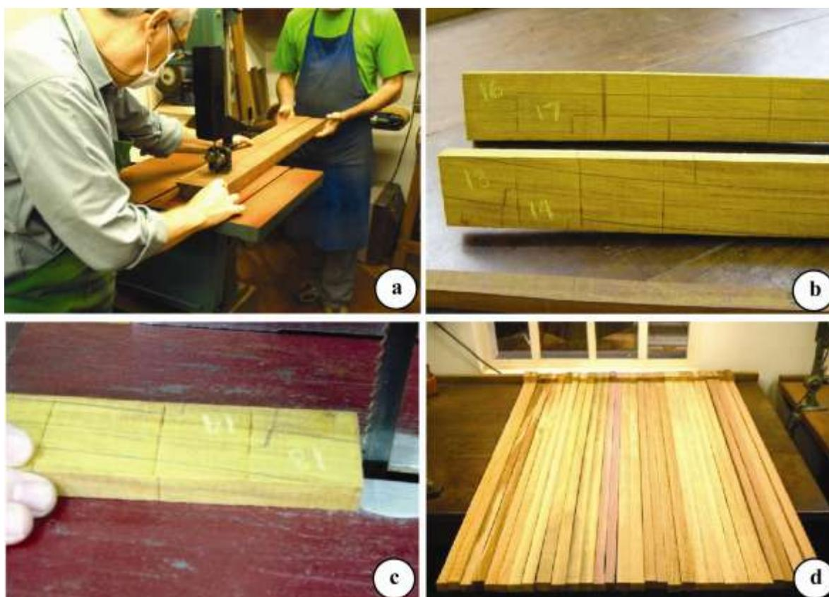
Figura 1. Preparação do material de estudo. a. Corte das peças para obtenção das varetas. b. Marcação das varetas nas peças. c. Corte das varetas. d. Aspecto geral de algumas das varetas empregadas no estudo. Fotos (b e c) de Erika Amano.
