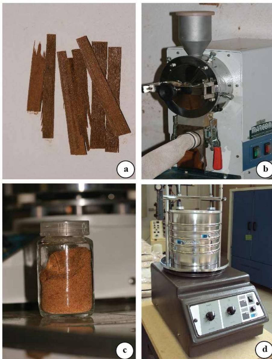
Figura 2. Procedimento para moagem das amostras de madeira. a. Amostras fragmentadas. b. Micromoinho de facas empregado para obtenção do pó. c. Pó obtido para as análises químicas. d. Peneiras classificatórias com malha no.16 (40 mesh) e no.24 (60 mesh). Foto (d) de Maria Regina Buch.
