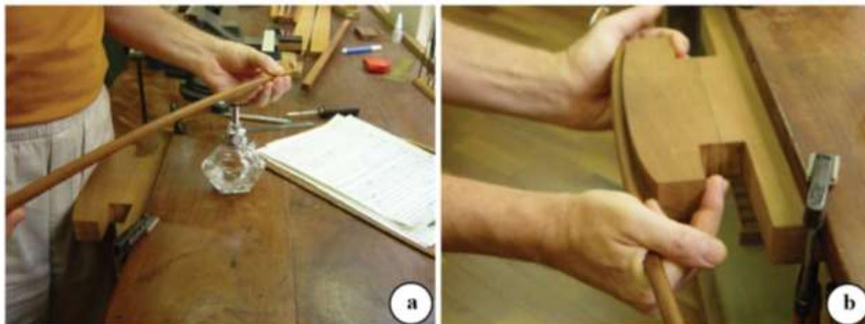
Figura 3. Encurvamento das varetas. a. Aquecimento da vareta com lamparina. b. Vareta sendo curvado sobre apoio para obtenção da curvatura. Fotos de Erika Amano.
