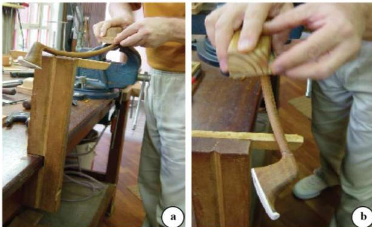
Figura 4. Lixamento das varetas. a. Procedimento executado na parte superior da vareta. b. Procedimento executado na lateral da vareta. Fotos de Erika Amano.
