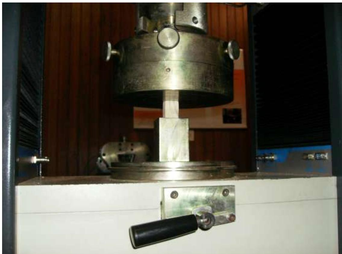
Figura 4. Corpo-de-prova em ensaio de compressão paralela às fibras. Foto de Israel Luiz de Lima.
