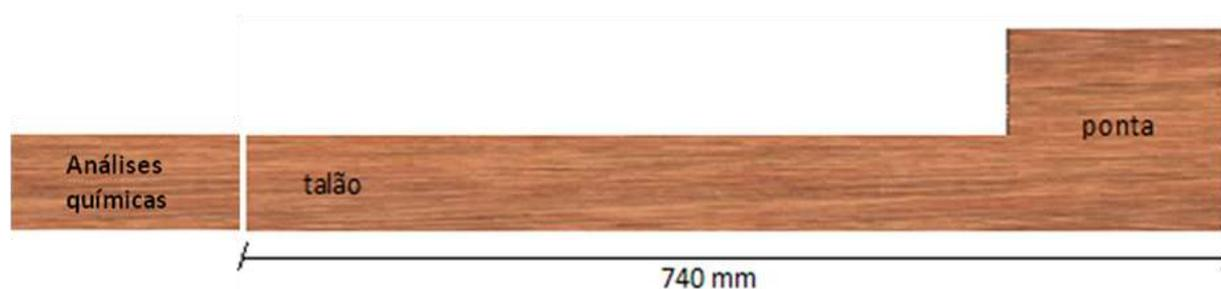
Figura 1. Representação esquemática da retirada dos corpos de prova para as análises químicas.
