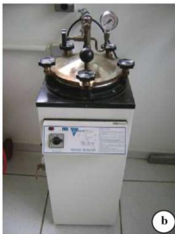
Figura 4. Equipamentos utilizados na obtenção da lignina residual e lignina solúvel. a. Banho ultratermostatizado Marconi. b. Autoclave vertical CS. Fotos de Maria Regina Buch.
