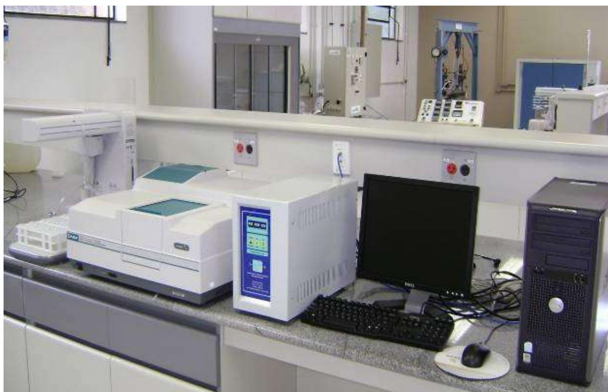
Figura 5. Espectrofotômetro Cary UV visível 100 CONC da Varian, utilizado para a obtenção dos valores de lignina residual. Foto de Maria Regina Buch.
