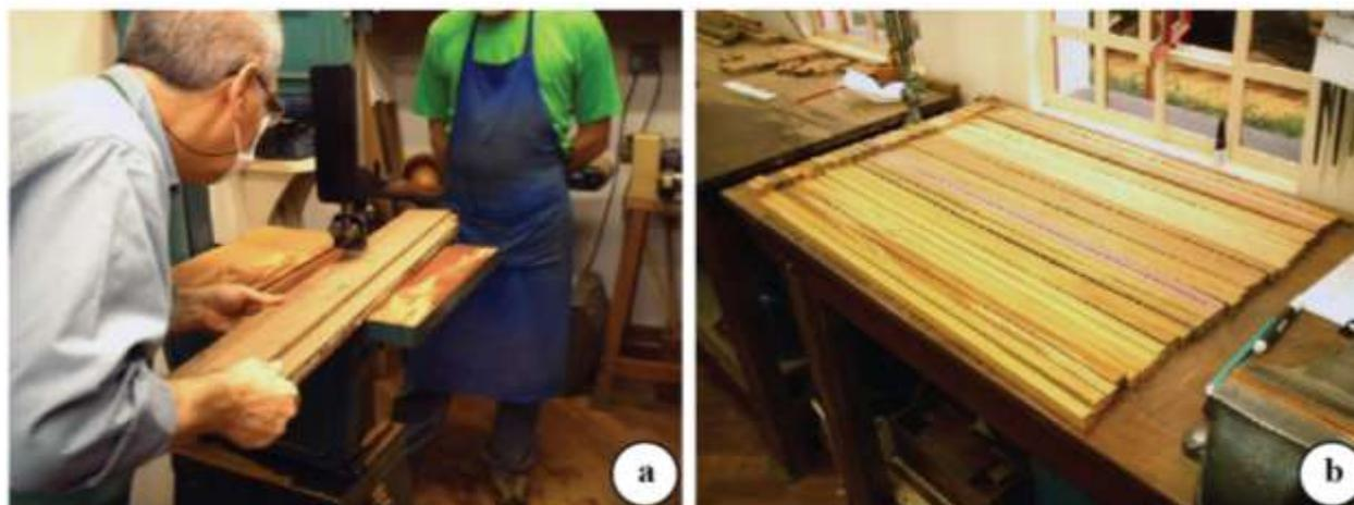
Figura 1. Desdobro das varetas. a. Corte de uma peça de *Diploptropis* spp. b. Algumas das varetas analisadas no estudo.
