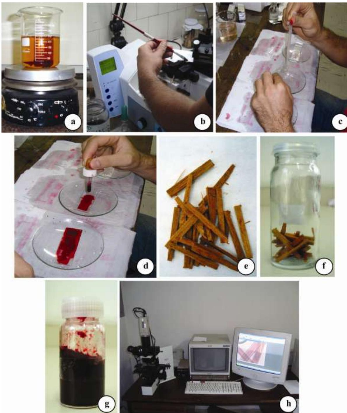
Figura 5. Preparação das madeiras para as análises anatômicas e avaliação ao microscópio. a. Cozimento dos corpos-de-prova. b. Seccionamento ao micrótomo de deslize. c. Clarificação das secções. d. Coloração das secções. e. Palitos retirados das extremidades do corpo-de-prova para preparação do lenho dissociado. f. Palitos acondicionados em vidro. g. Lenho dissociado pronto. h. Conjunto de equipamentos para captura, análise das imagens e mensuração das células.
