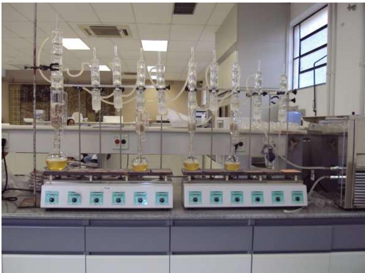
Figura 3. Conjunto para retirada dos extrativos composto de extratores soxhlet e aquecedor tipo sebelin da Marconi. Foto de Maria Regina Buch.
