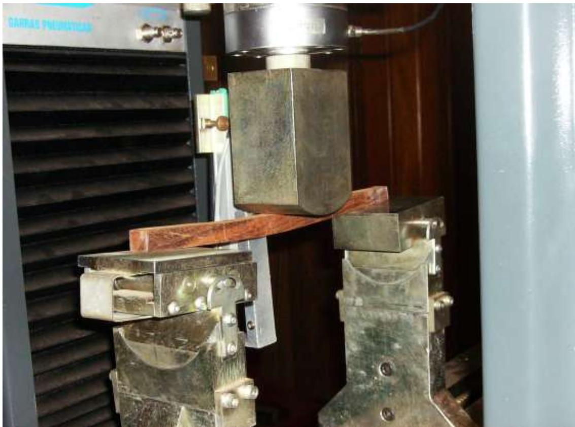
Figura 3. Vareta curta em ensaio destrutivo para a determinação do módulo de elasticidade estático e do módulo de ruptura. Foto de Israel Luiz de Lima.
