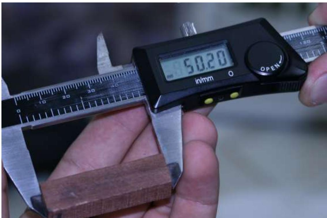
Figura 6. Determinação das dimensões dos corpos-de-prova, com paquímetro digital, para a avaliação da retração volumétrica.
