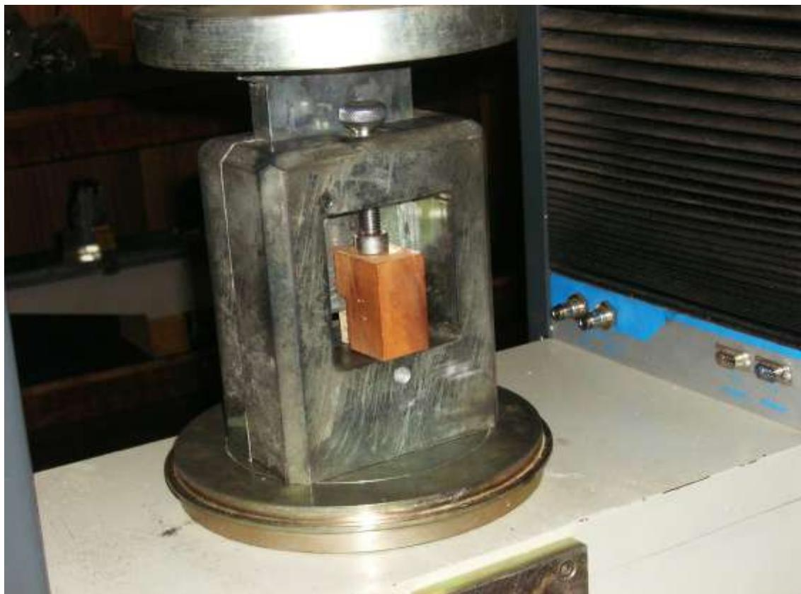
Figura 5. Corpo-de-prova em ensaio de cisalhamento. Foto de Israel Luiz de Lima.
