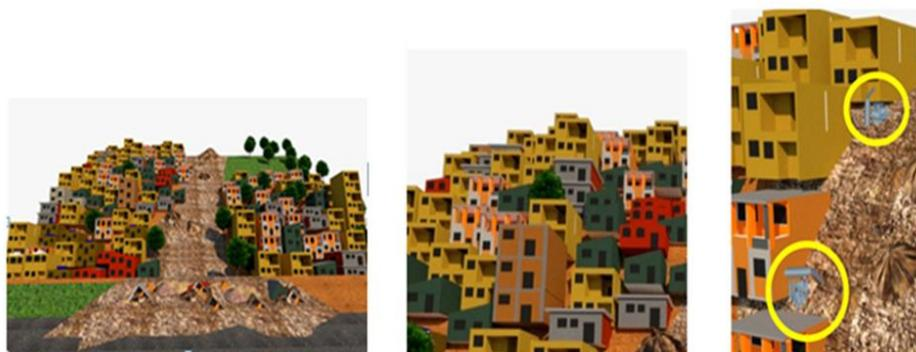
Figura 4 – Representação de características e fatores que contribuem para a ocorrência de escorregamentos. À esquerda, vista geral da área, com cicatriz de deslizamento e escombros. No centro, representação de padrão de ocupação sem planejamento urbano. À direita, detalhe de elementos (círculos amarelos) que contribuem para a instabilização do solo, no caso presença de tubulações com lançamento direto de águas servidas no talude.
