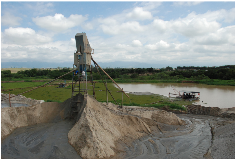
FOTOGRAFIA 17 - Pátio de classificação do material dragado caracterizado pelo predomínio de areias finas a médias; a fração silto-argilosa é descartada em bacia de decantação (à esquerda do classificador); e, a fração grânulo-seixo é reservada para outros usos (à direita). Porto Morro Vermelho, Guaratinguetá. (Fotografia: nov/2011)
