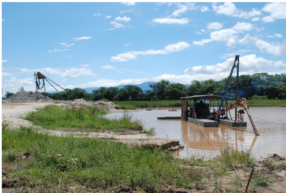
FOTOGRAFIA 1 - Método de lavra por dragagem em cava submersa, na planície de inundação do Rio Paraíba. A lança da draga (parte frontal da draga) tem acoplado o jato d'água para desmonte submerso e mangotes de sucção da polpa (material desmontado + água), que é conduzida diretamente para o classificador (canto esquerdo, ao fundo). Porto Agimix, Lorena (Fotografia: nov/2011).
