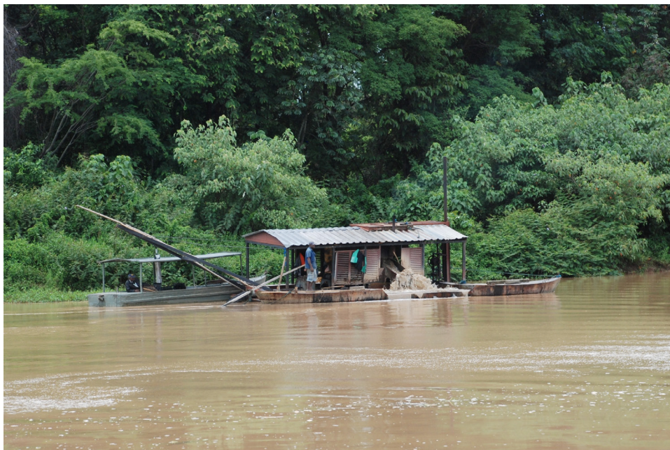
FOTOGRAFIA 4 - Dragagem no leito ativo do Rio Paraíba, com sistema de bombeamento sobre barcaça móvel, que transporta o minério até a margem, onde se localiza o pátio com as estruturas de classificação e estocagem. O descarregamento é efetuado, também, por bombeamento. Porto Irmãos Cardoso, Cruzeiro (Fotografia: nov/2011).
