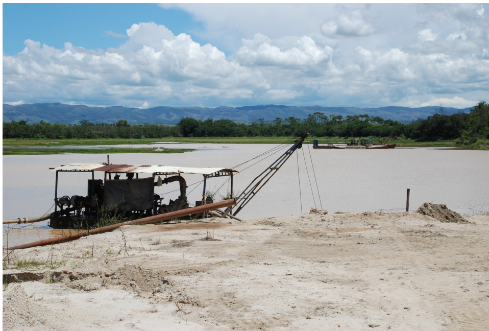
FOTOGRAFIA 22 - Vista geral da extração de areia em cava através da dragagem e sucção, onde se vê que a lâmina d'água da cava se confunde com a superfície plana do terreno, ao fundo. Mais ao fundo ainda, atrás da linha de mata, situam-se o canal fluvial ativo do Rio Paraíba do Sul e, no horizonte, a Serra da Mantiqueira. Porto Lara (Cava Pescador), W de Cachoeira Paulista (Fotografia: nov/2011).
