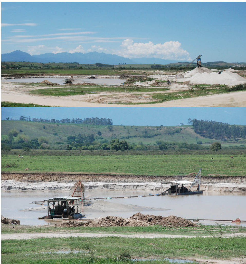
FOTOGRAFIA 2a (superior) - Vista geral de extração em cava submersa, com a formação de “praia” por sedimentos bombeados da draga de desmonte (ao fundo) e, retomada deste material por outra draga (à frente), através de sucção e bombeamento para uma estação fixa de classificação (canto direito). FOTOGRAFIA 2b (inferior) - Detalhe da dragagem com formação de “praia”. Porto CAJ, Cachoeira Paulista. (Fotografia: out/2012).
