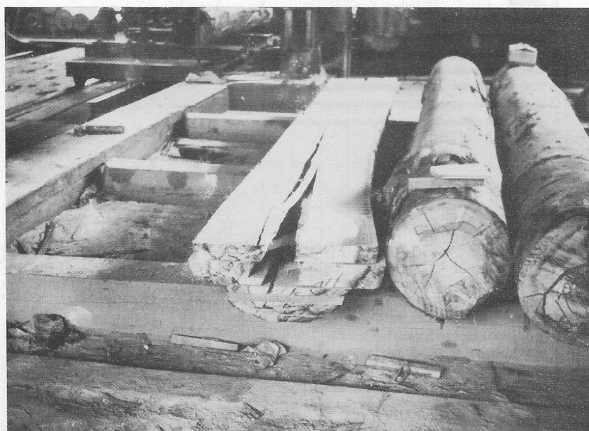
Fot. 4 e 5 — Método 3: rachamento quase completo das tábuas, principalmente daquelas que ocupam posição diametral ou próxima a ela.
