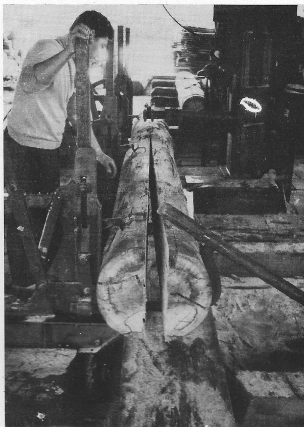
Fot. 2 — Durante a operação de desdobro pelo método 1, quando se executavam cortes diametrais, a parte livre distanciava-se da estaca presa às garras do carro.
