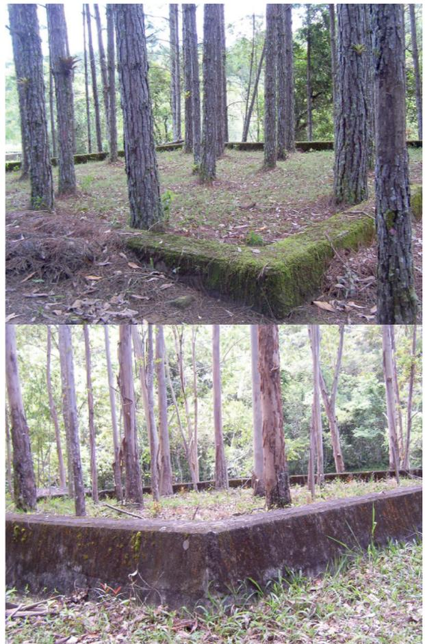
Figura 1. À esquerda: esquema com vista de cima dos lisímetros e corte transversal de um deles. Sem escala e valores em metro. À direita: fotos dos lisímetros com pinus (acima) e eucalipto (abaixo).
