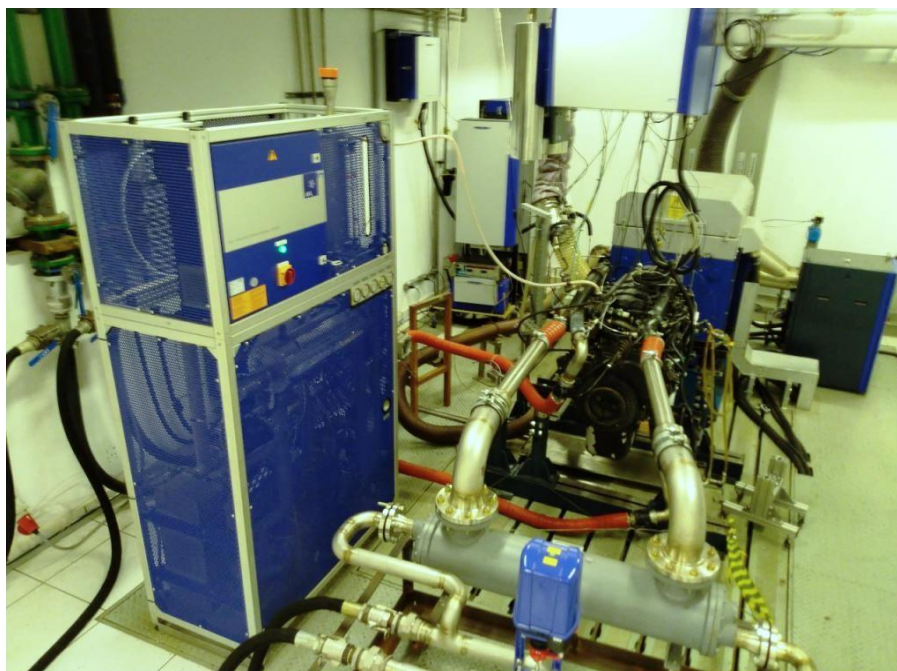
Fotografia 6 - Laboratório de emissão veicular descentralizado: dinamômetro de bancada
