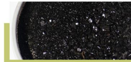
Plano detalhe de placa de fração de lignina extraída com solvente verde.
