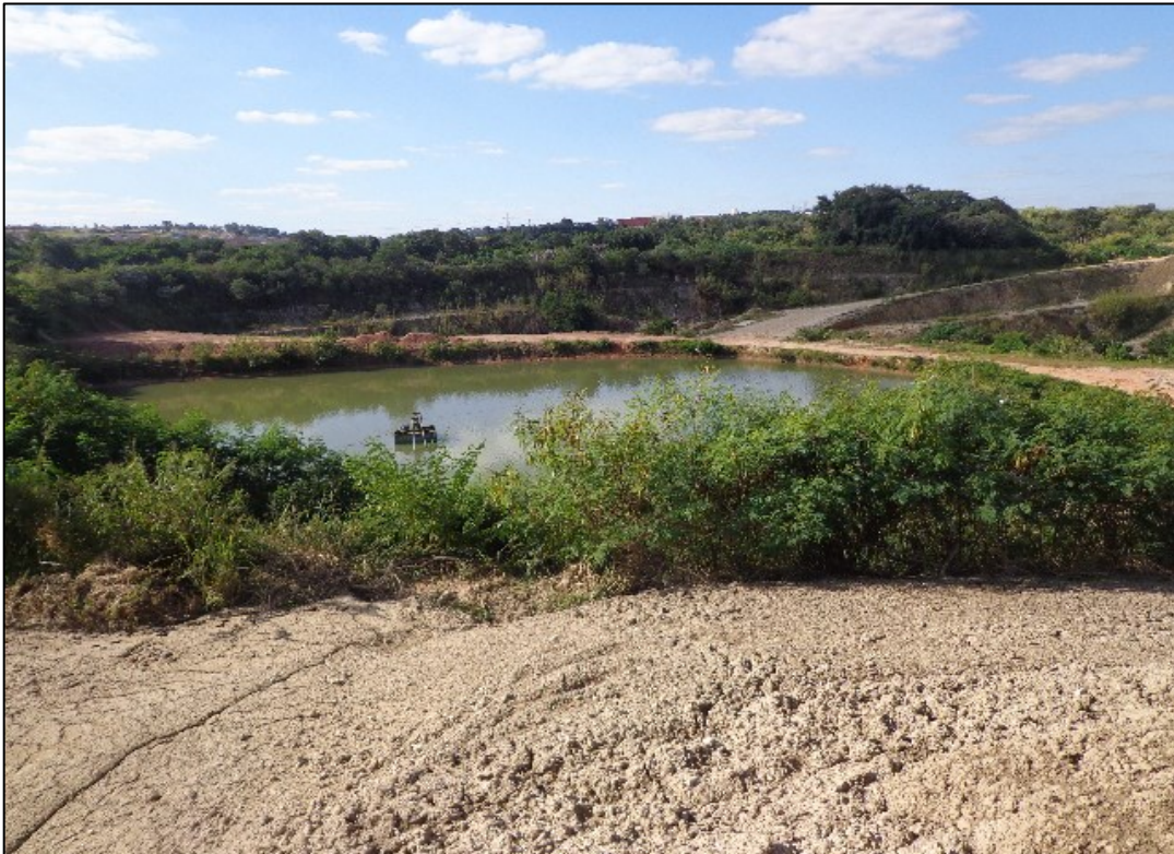
Foto 35 - Bacia de contenção de água que é utilizada (em circuito fechado) no processo produtivo de areia (Itabrás Mineração).
