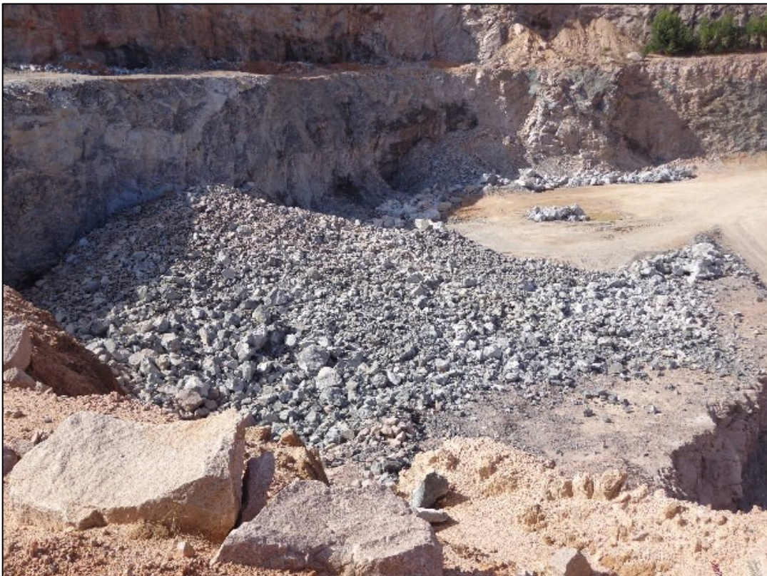
Foto 2 - Resultado do desmonte rochoso primário por explosivos na frente de lavra atual (Pedreira Tavares Pinheiro).
