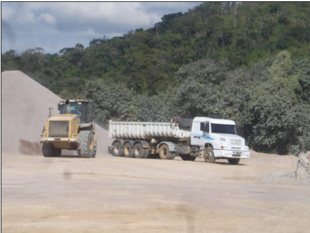
Foto 20 - Operação de carregamento de brita para expedição (Pedreira Embu).
