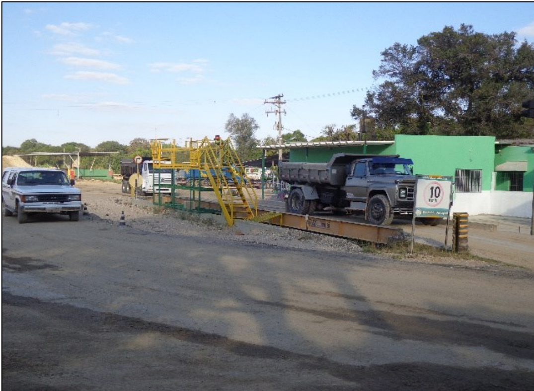
Foto 39 - Escritório e balança eletrônica de pesagem dos caminhões de transporte (expedição) de areia (Porto de Areia Rio Branco/Itabrás Mineração).
