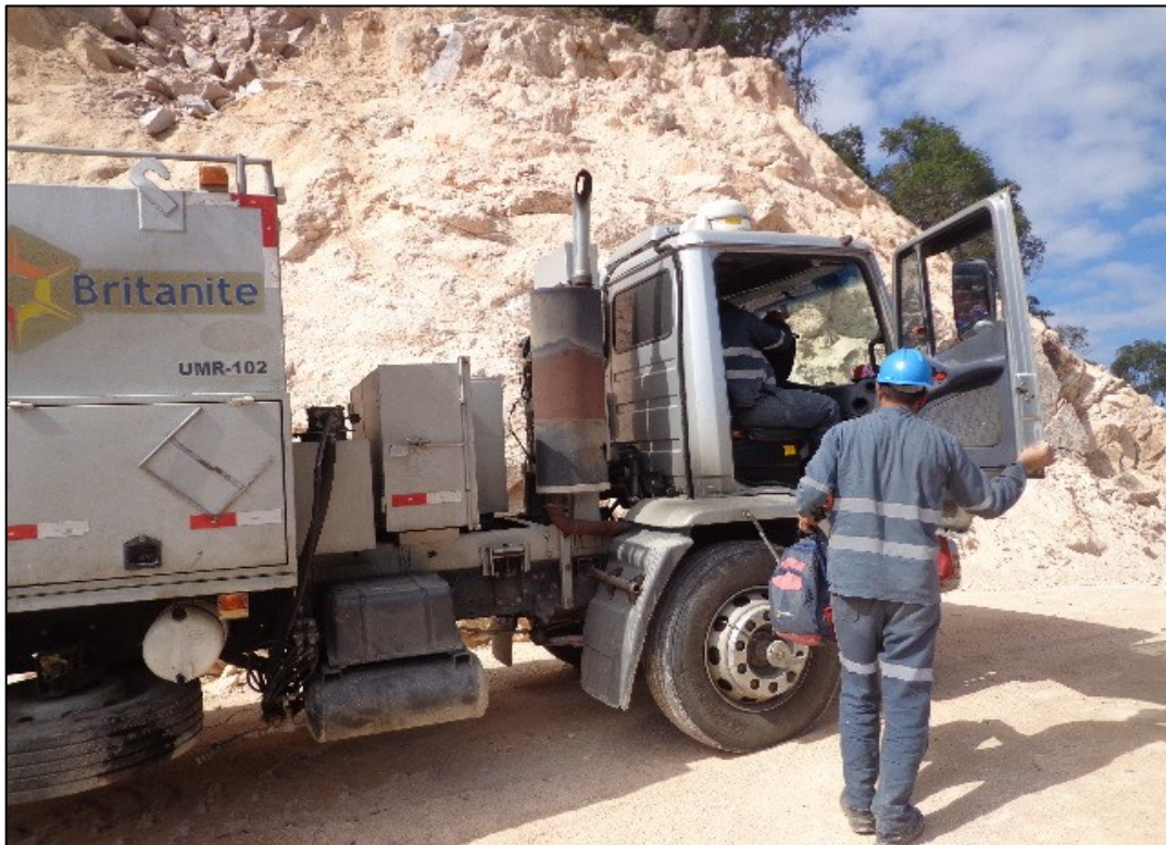
Foto 5 - Unidade móvel de fornecimento (serviço terceirizado) de explosivo bombeado (Pedreira Tavares Pinheiro).
