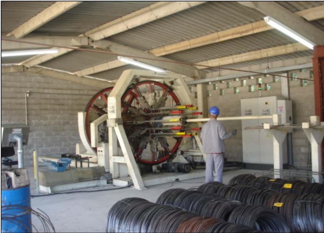
Foto 13 - Detalhe de operação utilizada na construção de tubos de concreto (Pedreira Tavares Pinheiro).
