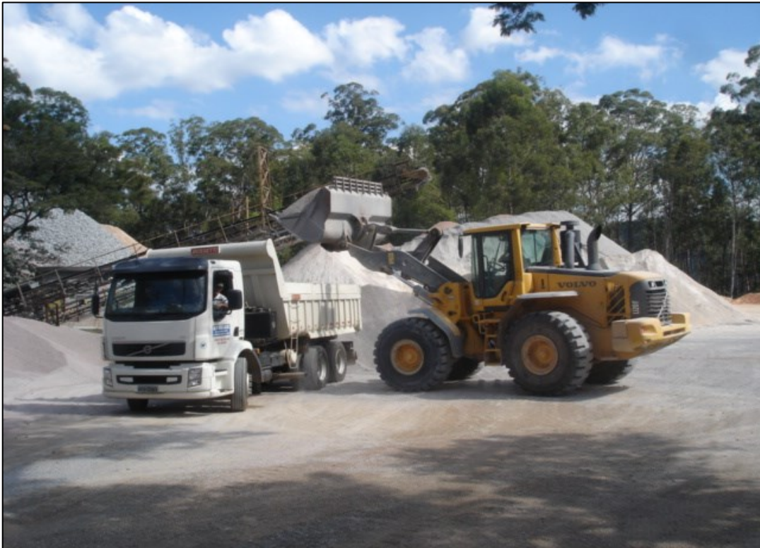
Foto 9 - Operação de carregamento de brita para expedição (Pedreira Tavares Pinheiro).
