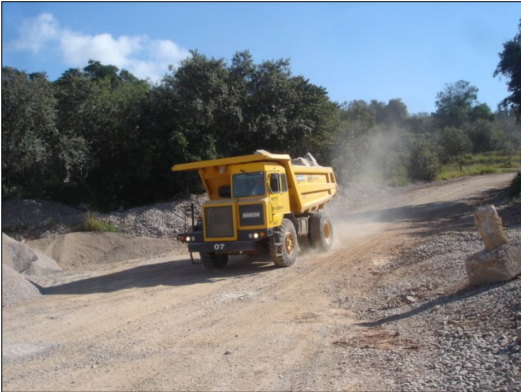
Foto 17 - Transporte de rocha por caminhão fora-de-estrada até o britador primário (Pedreira Embu).
