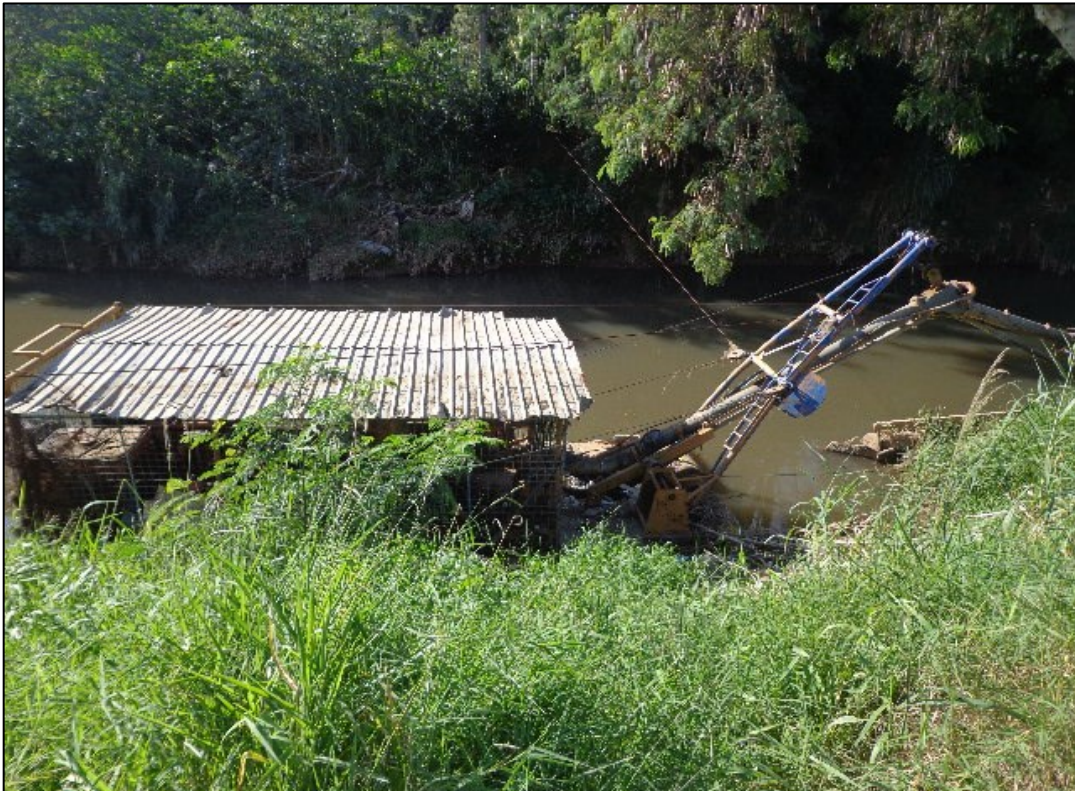
Foto 37 - Barcaça (paralisada) utilizada na dragagem hidráulica no leito do rio Jundiá (Porto de Areia Rio Branco/Itabrás Mineração).
