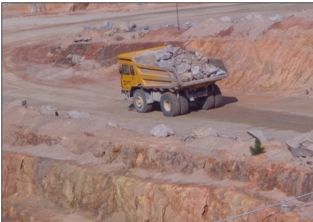
Foto 4 - Transporte de rocha por caminhão fora-de-estrada até o britador primário (Pedreira Tavares Pinheiro).
