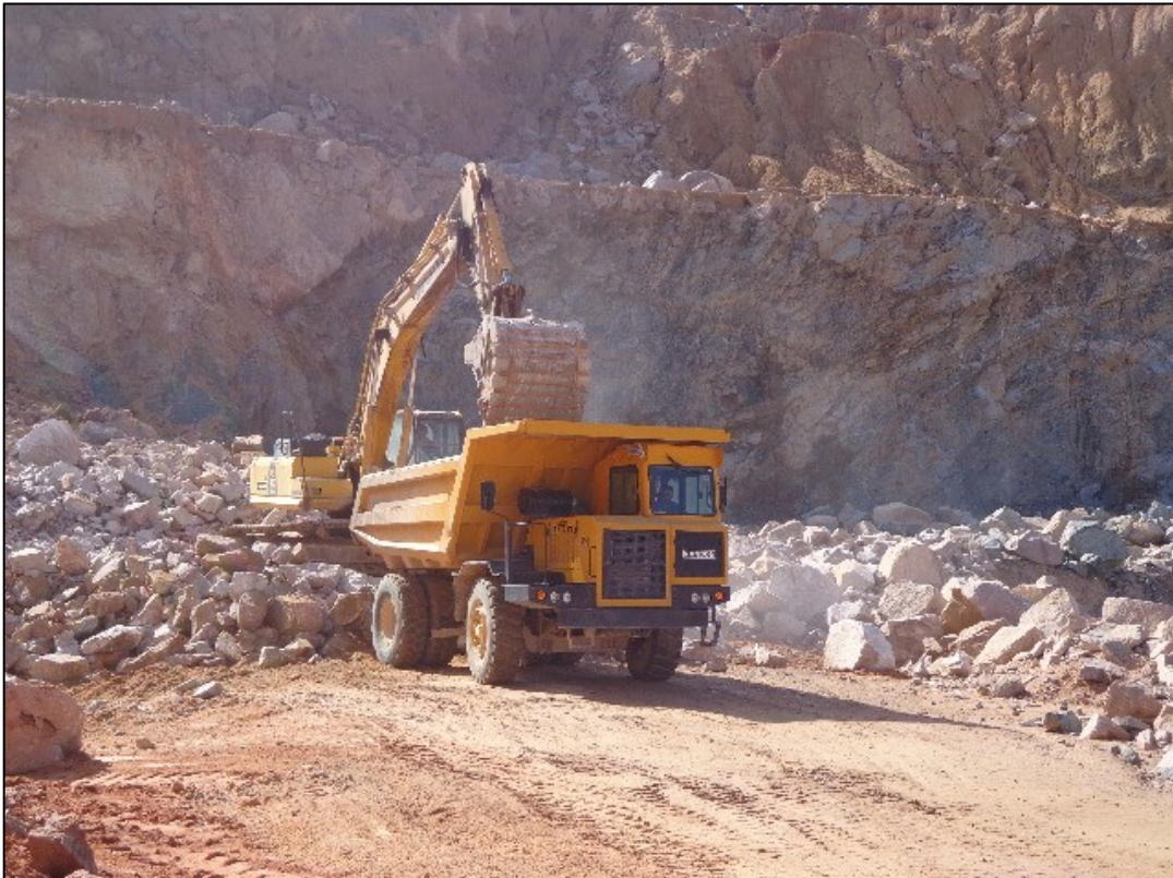
Foto 3 - Operação de carregamento de rocha na frente de lavra atual (Pedreira Tavares Pinheiro).
