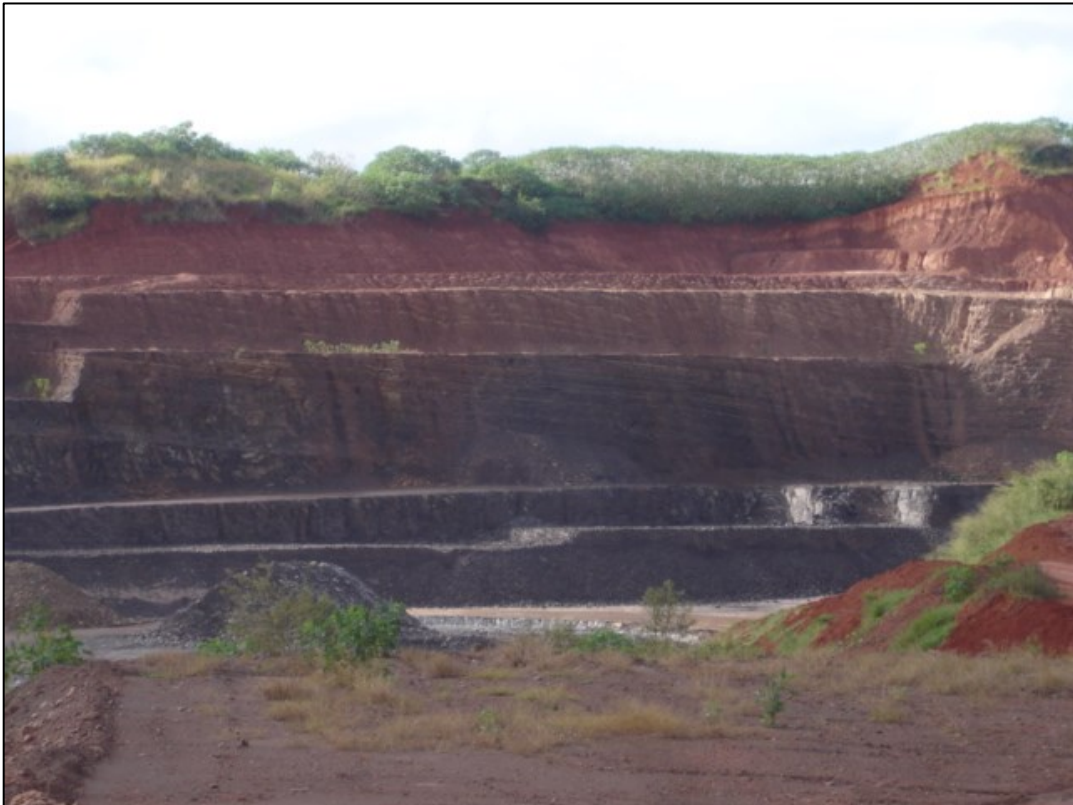
Foto 61 - Situação atual dos taludes das frentes atuais de lavra de argila (Mineração Gresca).
