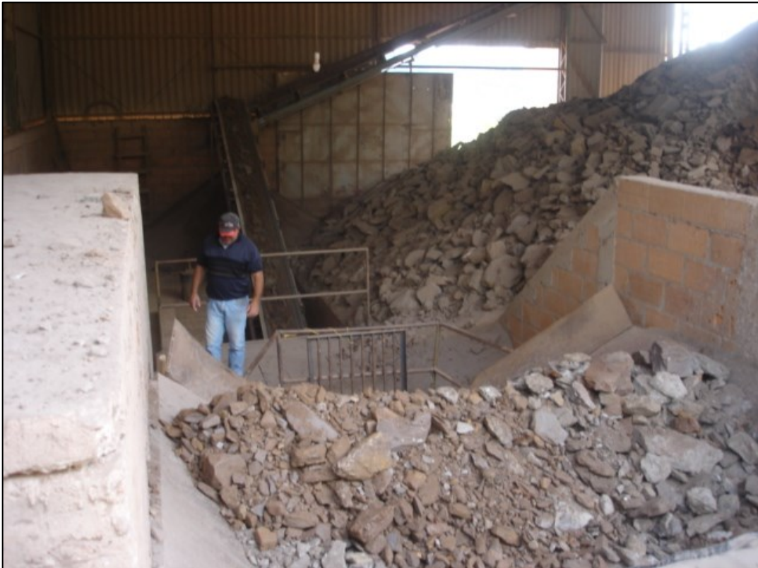
Foto 65 - Local de alimentação do britador para operação de fragmentação primária da argila (Mineração Gresca).
