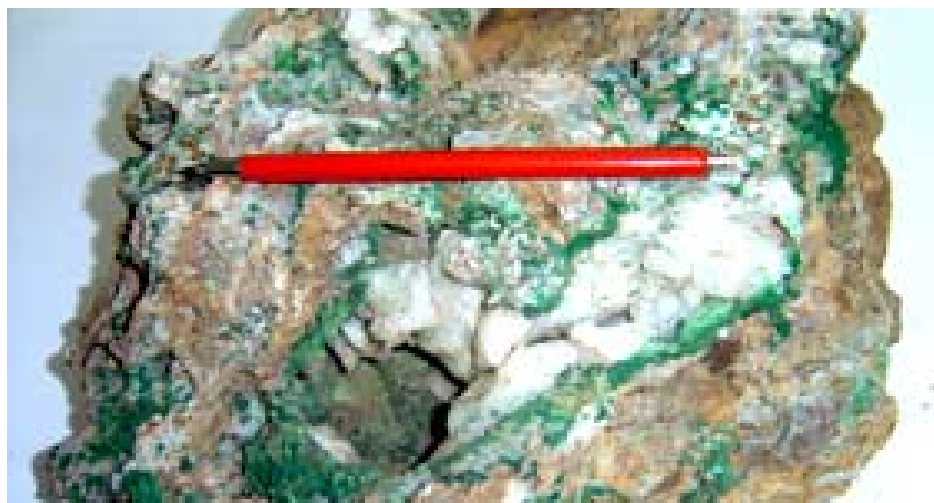
Foto 17 – Minério de cobre representado por uma mistura de carbonatos e silicatos hidratados de cobre juntamente com óxidos de ferro, sílica na forma de quartzo e raramente, metais nobres como ouro.
