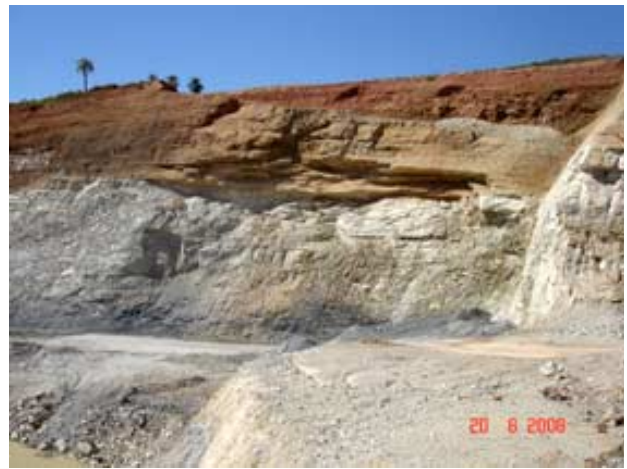
Foto 10 – Jazimento de filito branco sotoposto a arenitos rosados da Formação Furnas. Direito de lavra em nome da Mineração Nova Fronteira que destina o bem mineral para a indústria cerâmica.
