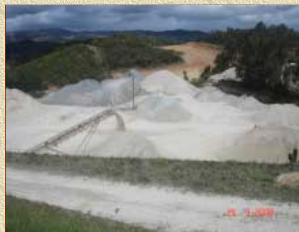
Vista de cima do pátio de britagem do filito e estocagem do mesmo.
