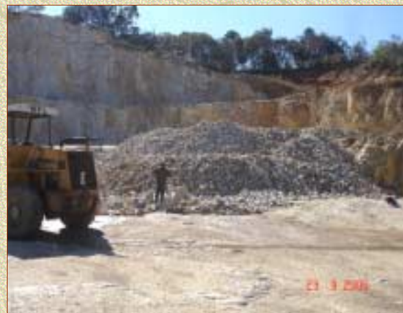
Material é extraído com uso de explosivos e blocos reduzidos manualmente (marreta).
