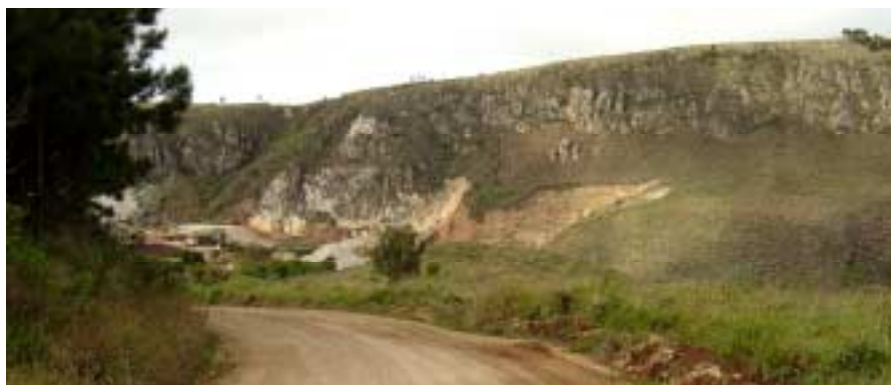
Foto 12 – Elevação constituída por quartzito atualmente explorada para metalurgia. Concessão de lavra pertencente à Mineração Nova Fronteira. O material é fornecido para a Cia. Maringá entrando como matéria prima na metalurgia de ligas contendo silício.
