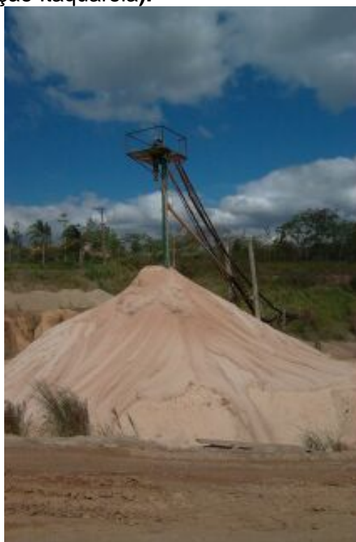
Foto 14 - Recuperação de areia fina utilizando operação de hidrociclagem (Porto 9 da Mineração Itaquareia).
