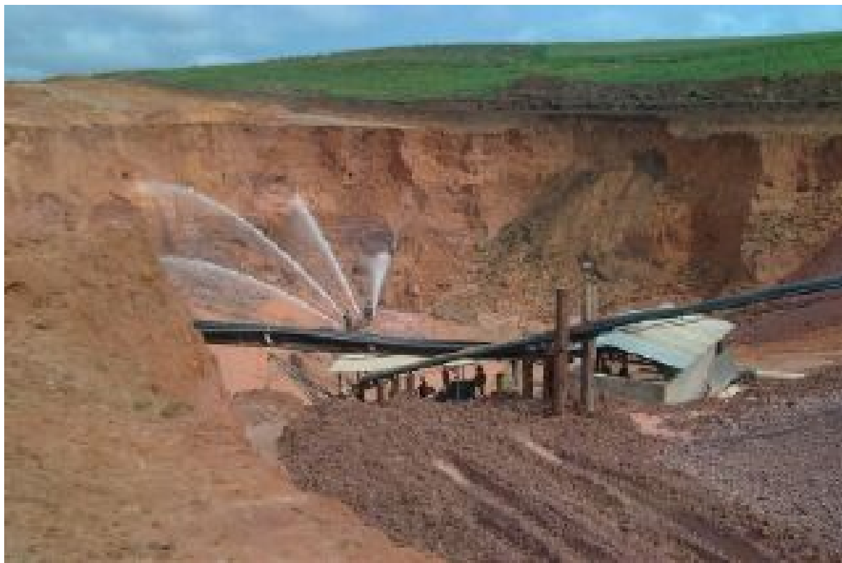
Foto 7 – Avanço da lavra por desmorte hidráulico com formação da cava (Ponte Alta da Mineração Itaquareia).
