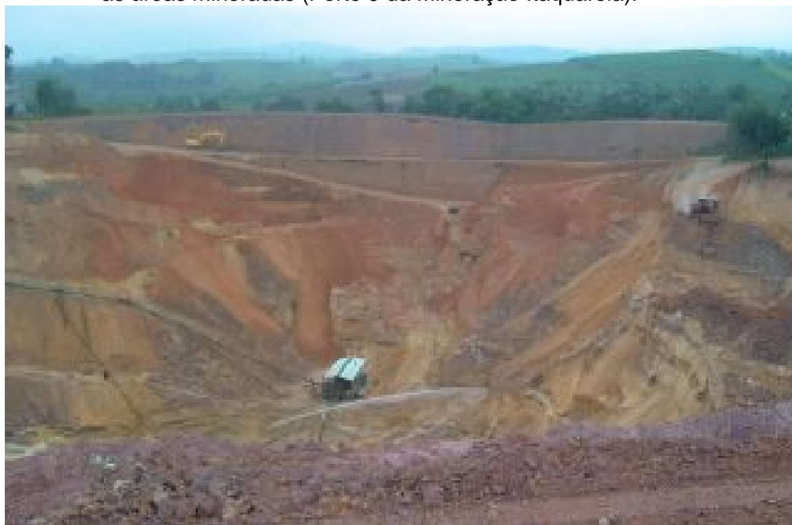
Foto 16 – Avanço da lavra por desmonte hidráulico com formação de cava (Minerações Areima e Três Coroas integradas).
