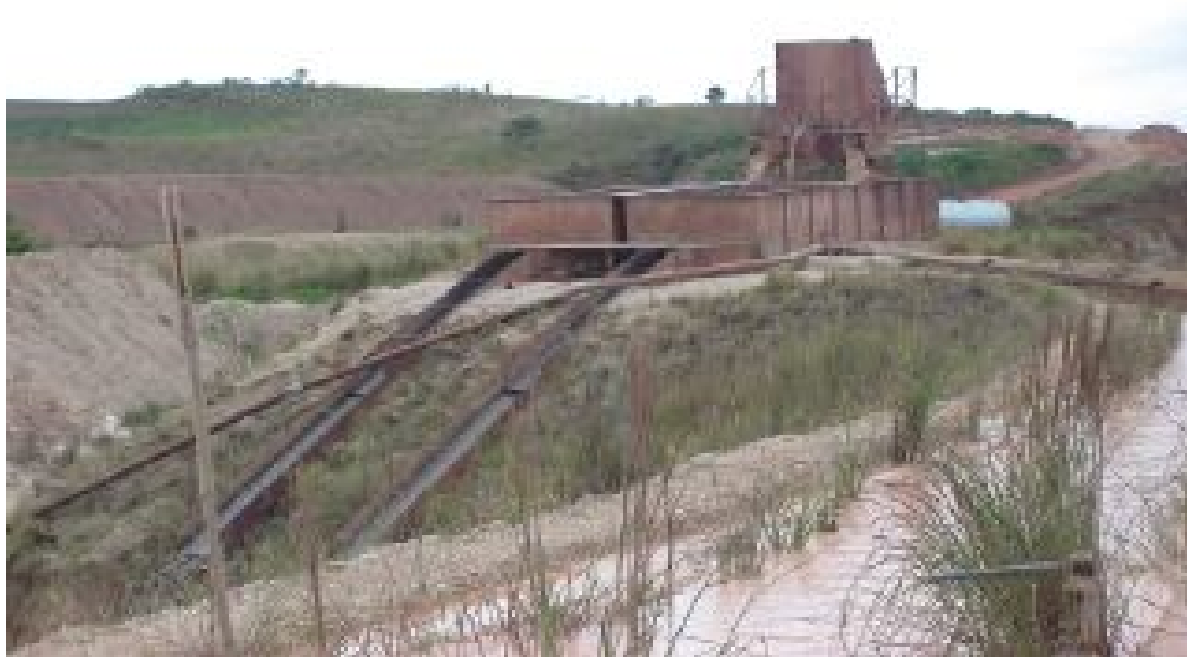
Foto 3 – Sistema de lavagem de areia com reaproveitamento de água em circuito fechado (Mineração Taboão).
