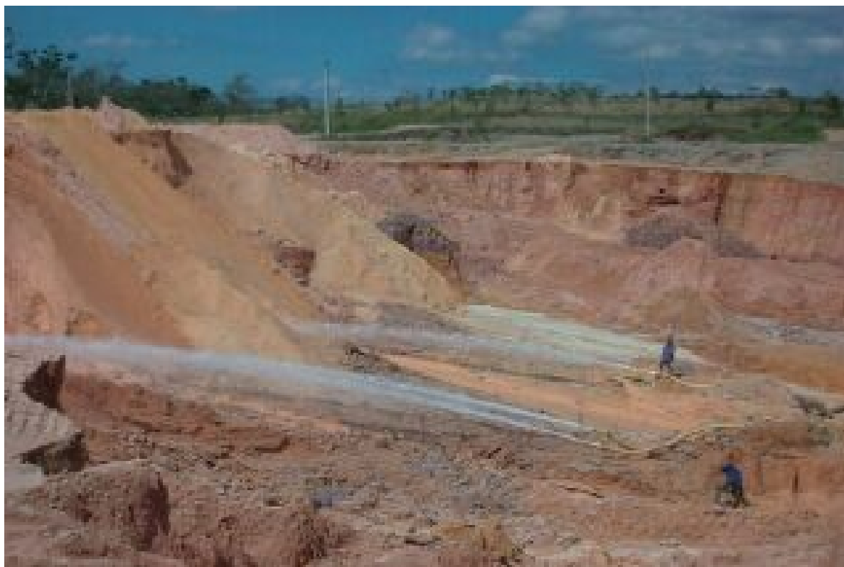
Foto 13 – Avanço da lavra por desmonte hidráulico com formação de cava (Porto 9 da Mineração Itaquareia).
