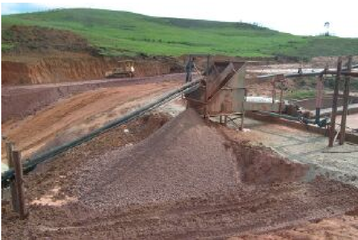
Foto 6 – Unidade de peneiramento para separação da fração cascalho contido na polpa bombeada (Ponte Alta da Mineração Itaquareia).
