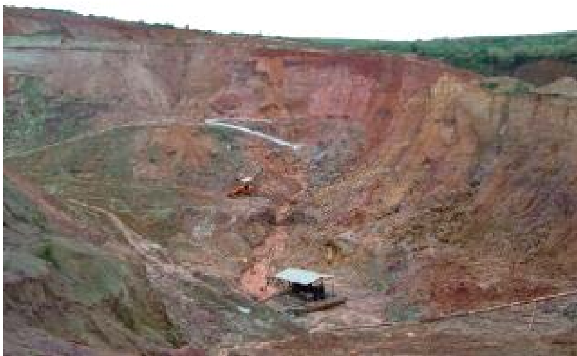
Foto 2 – Avanço da lavra por desmonte hidráulico com formação de cava (Mineração Taboão).
